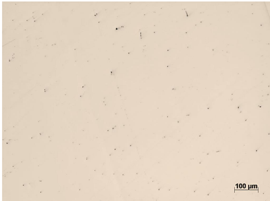
Figura 4.12: Inclusões de Óxidos tipo 2 fina (aumento 100x) no aço SAE 1070.
