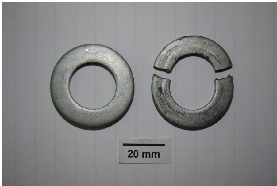
Figura 3.1: Amostras das molas prato fabricadas em aço SAE 1060 e SAE 1070 respectivamente (LAMEF-UFRGS).
