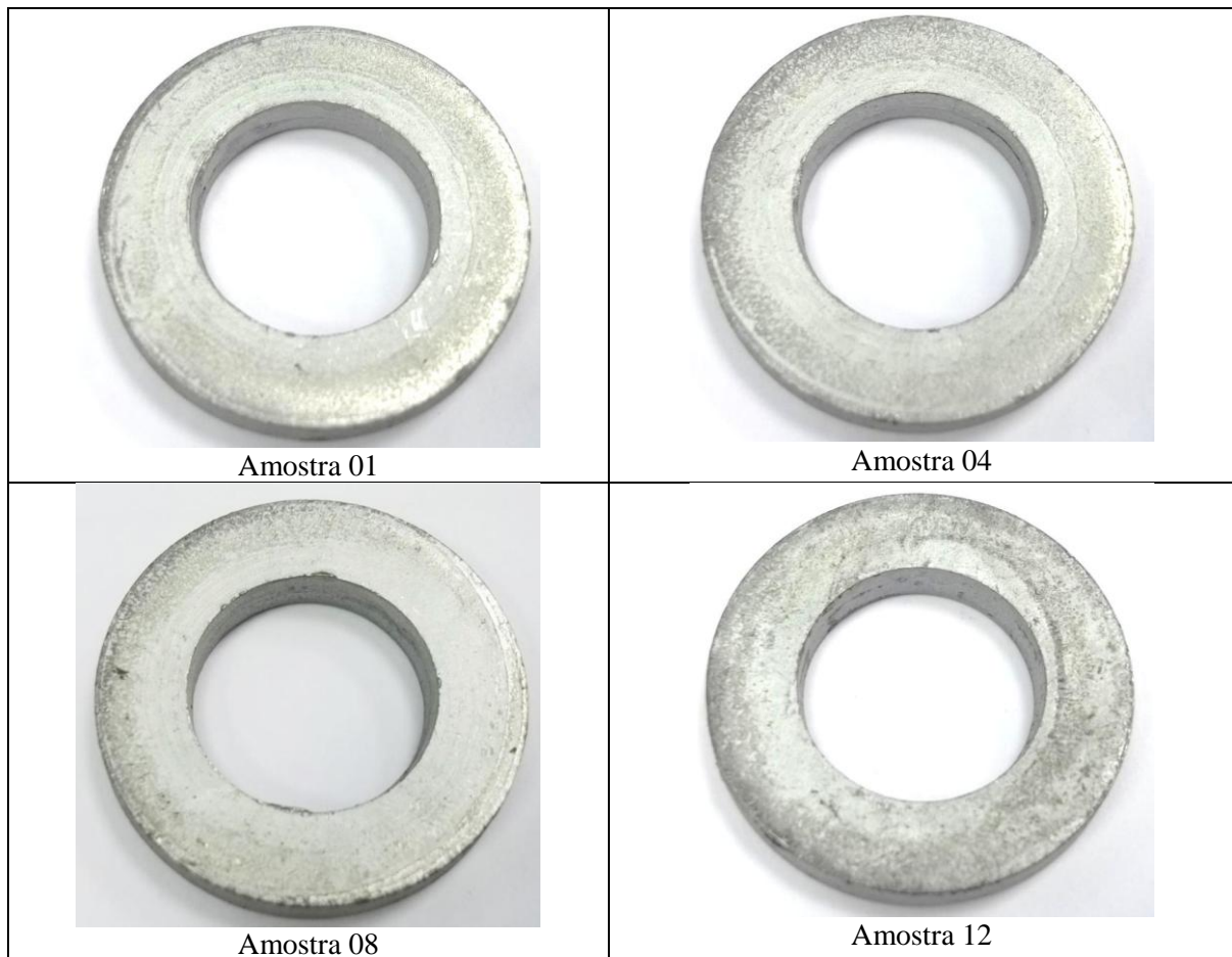
Figura 4.2: Mostra imagens que evidenciam que as molas prato SAE 1060 não fraturaram após os ensaios.
