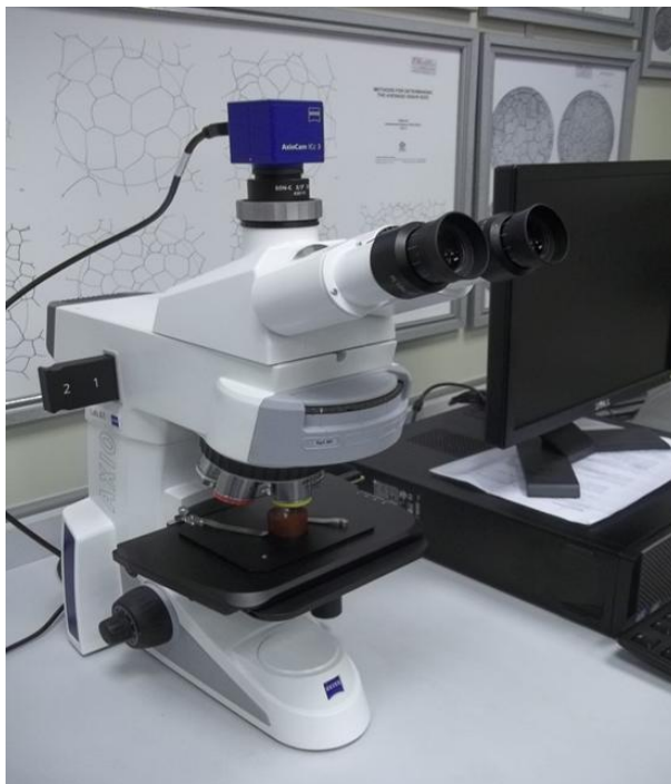
Figura 3.8: Mostra microscópio com computador para aquisição das imagens micrográficas das amostras.
