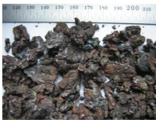
Figura 41 – Escória sólida formada no molde em uma corrida com alto teor de silício dissolvido.
