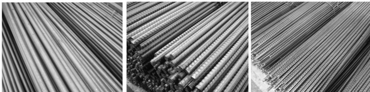
Figura 13 – Vergalhões comercializados no Brasil. À esquerda: CA-25 (barra lisa). No centro: CA-50 (barra nervurada). À direita: CA-60 (fio nervurado).
