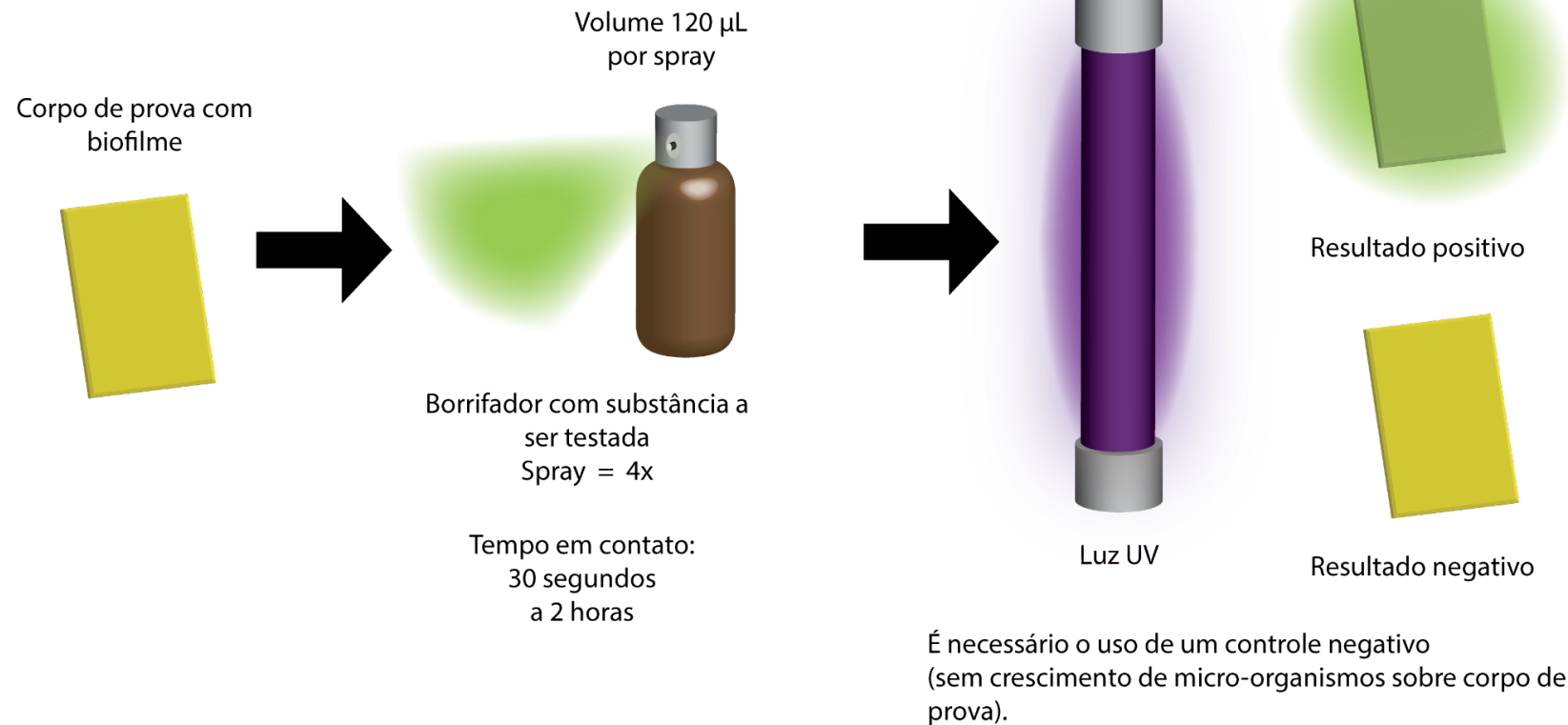
Figura 7. Esquema ilustrando teste de marcação do biofilme sobre corpo de prova com substância fluorescente.
