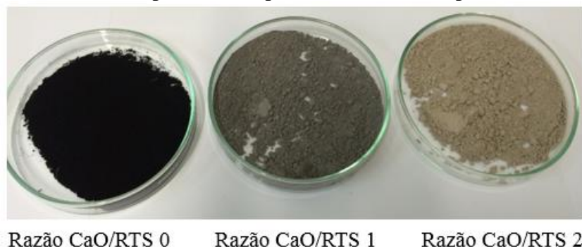
Figura 3.10. Amostras do char produzido a partir dos ensaios de pirólise do RTS.
