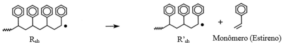
Figura 2.14. Reação de decomposição na posição \beta .
