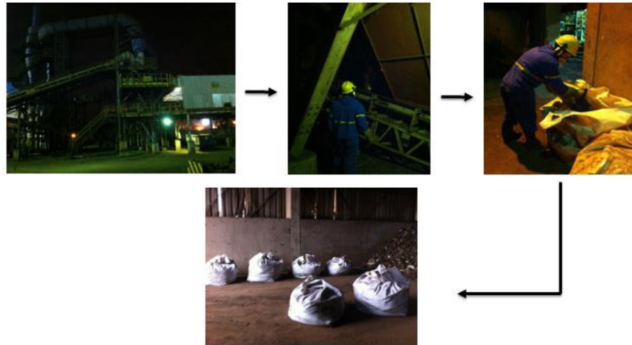
Figura 3.1. Procedimento de amostragem na indústria siderúrgica.
