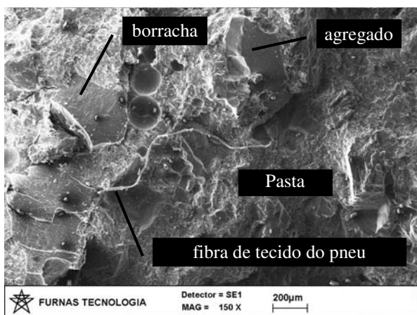
Figura 62: 4,8T10. Aspecto geral da amostra. Bolhas de ar maiores e com menor incidência. Ar aprisionado = 1,9%.
