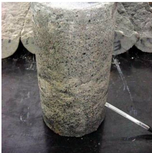
Figura 16: Corpo-de-prova ilustrando a segregação das partículas de borracha. A caneta indica a região de segregação que, na moldagem, era o topo do corpo-de-prova (ALBUQUERQUE et al. , 2004a).
