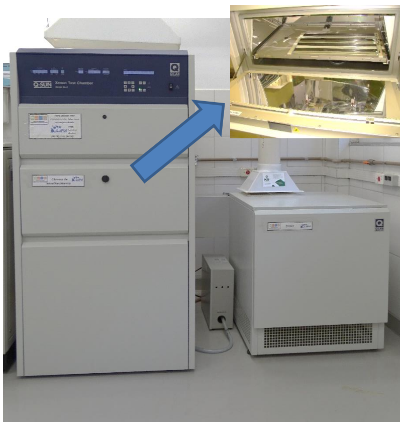
Figura 27. Imagens da câmara de envelhecimento acelerado ( weatherometer ) do LAPOL/UFRGS, com a apresentação da janela de radiação: hastes expostas e espelhos no interior da câmara.
