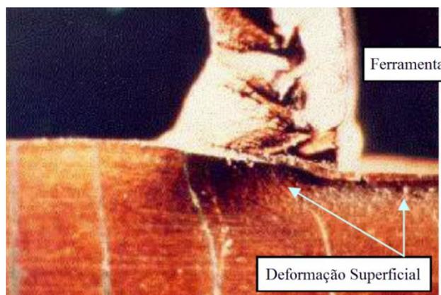
Figura 2.26 – Deformação plástica na usinagem [Astakhov, 2010].
