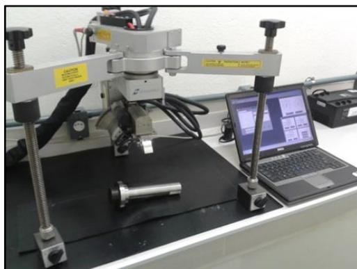
Figura 3.10 – Medição utilizando o analisador de tensão residual X-Stress 3000.
