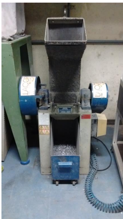
Figura 18 – Moinho de facas marca Rone, modelo SRB 2305 utilizado.
