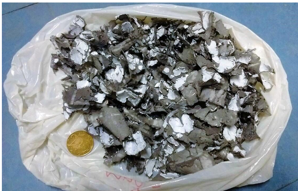
Figura 22 – Porção do material do módulo “C” perdido no processo de cominuição. Uma moeda é apresentada na figura como referência de escala.
