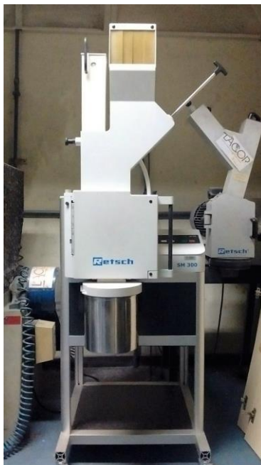
Figura 20 – Moinho de facas da marca Restch, modelo SM300, utilizado para a moagem do módulo C, amostra PV2.
