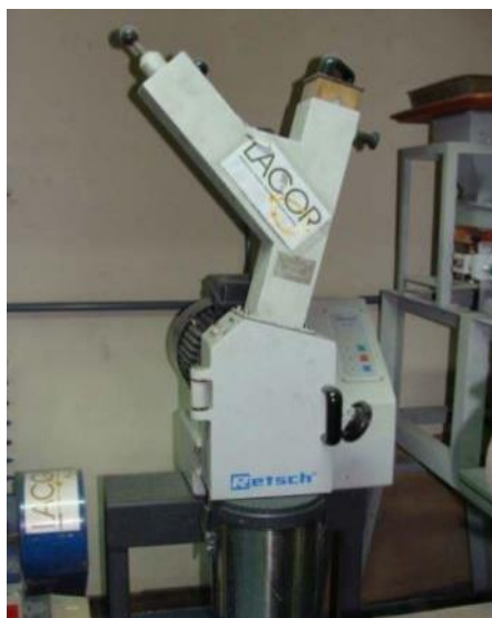
Figura 19 – Moinho de facas da marca Retsch, modelo SM2000. Adaptado de RIBEIRO DIAS, 2015.
