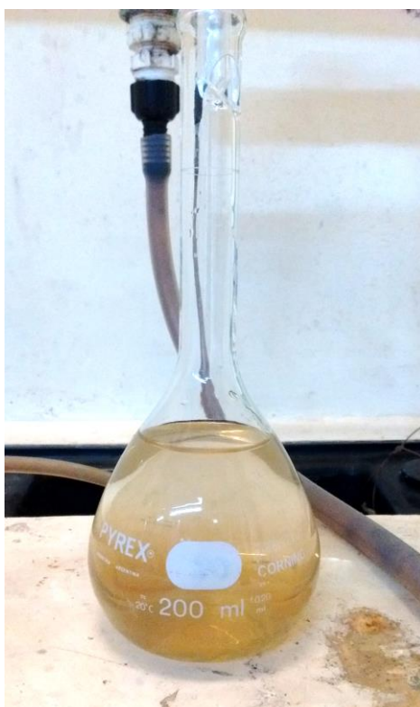
Figura 24 – Solução de 0,8M de tiosulfato, 0,2M de \text{NH}_4\text{OH} e 0,05M \text{CuSO}_4 – ensaio 9 - em processo de filtração.
