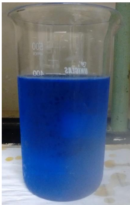
Figura 23 – Solução de tiosulfato de sódio (0,2M), hidróxido de amônio (1M) e \text{Cu}^{2+} (0,05M) pós-lixiviação. A coloração azul permaneceu inalterada após o processo.
