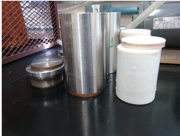
Figura 7: Reator cilíndrico de aço-inox com cápsula interna de teflon (150 mL) utilizado para a síntese de zeólitas.
