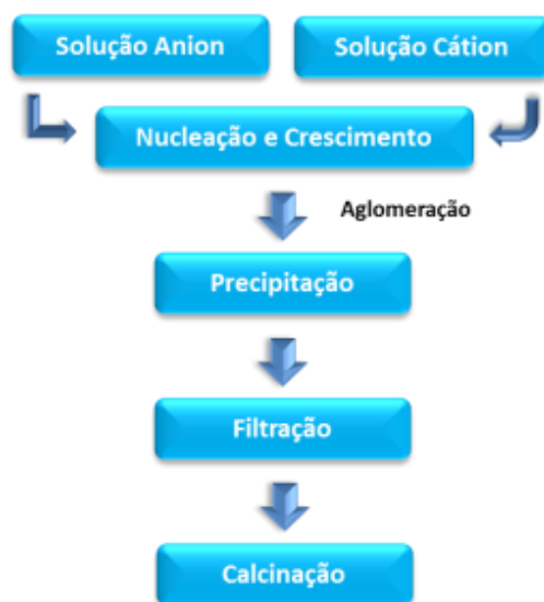
Figura 3.20. Fluxograma da síntese por coprecipitação.
