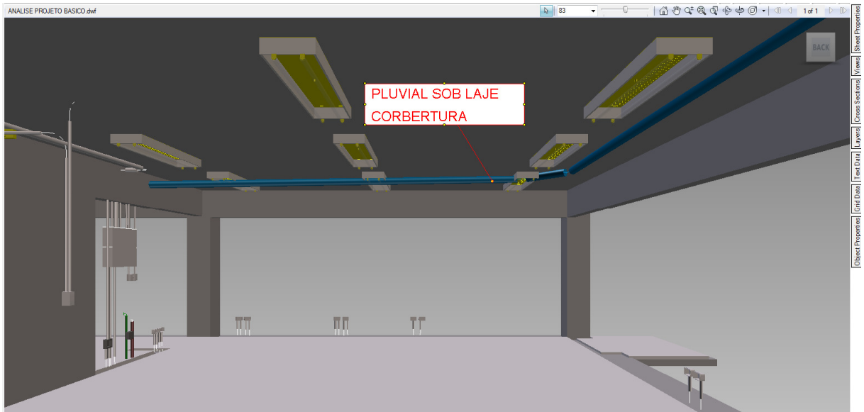
Figura 41 – Relatório Compatibilização DWF - Perspectiva do conflito da drenagem do pavimento ático no 6º Pavimento - Anteprojeto.
