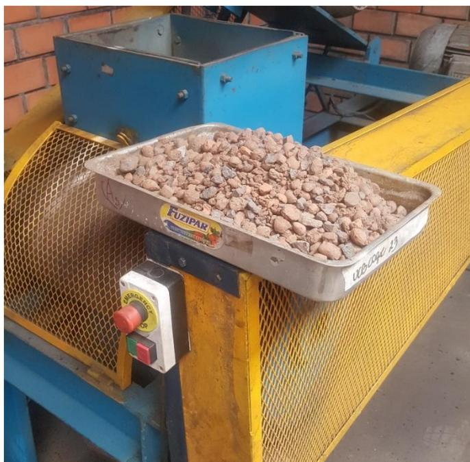
Figura 13. Ilustração do britador de rolos *Maqbrit*, LAPROM – UFRGS.
