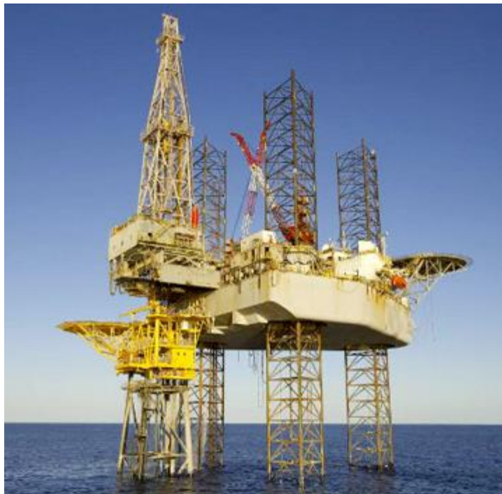
Figura 11 - Exemplo de plataforma auto-elevatória.
