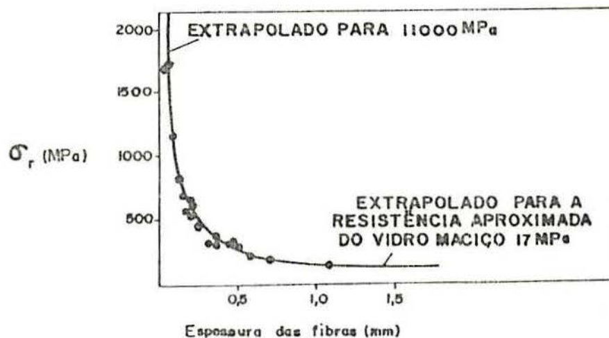
Fig.2.1.1- Resultados obtidos por Griffith em ensaios de tração de fibras de vidro.
