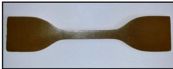
Figura 10. Imagem ilustrativa do corpo de prova usado nos ensaios de Tensão e Alongamento.
