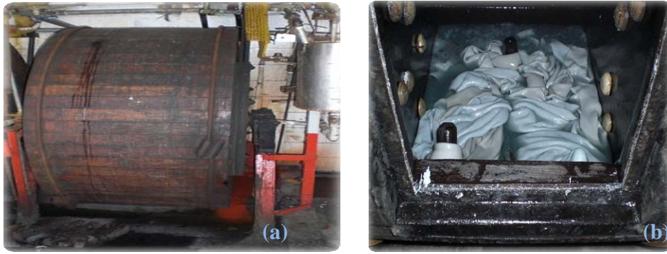
Figura 3.8: Ilustração do fulão de testes
