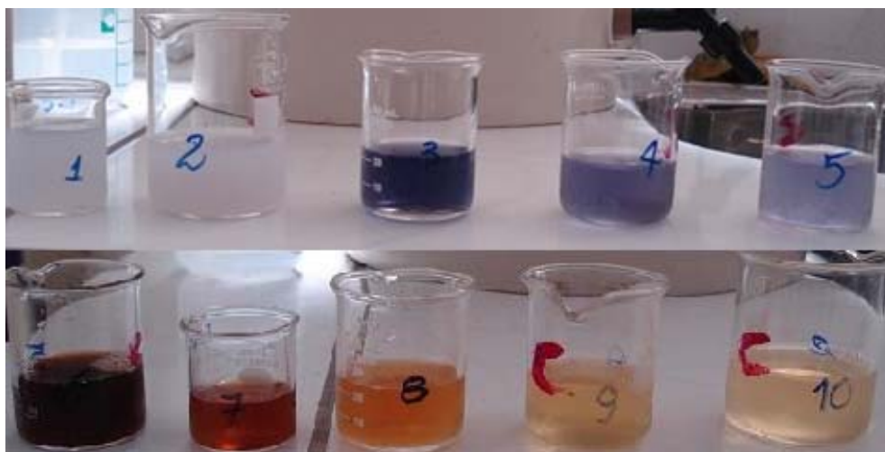
Figura 4.9: Banhos residuais do acabamento molhado com redução
