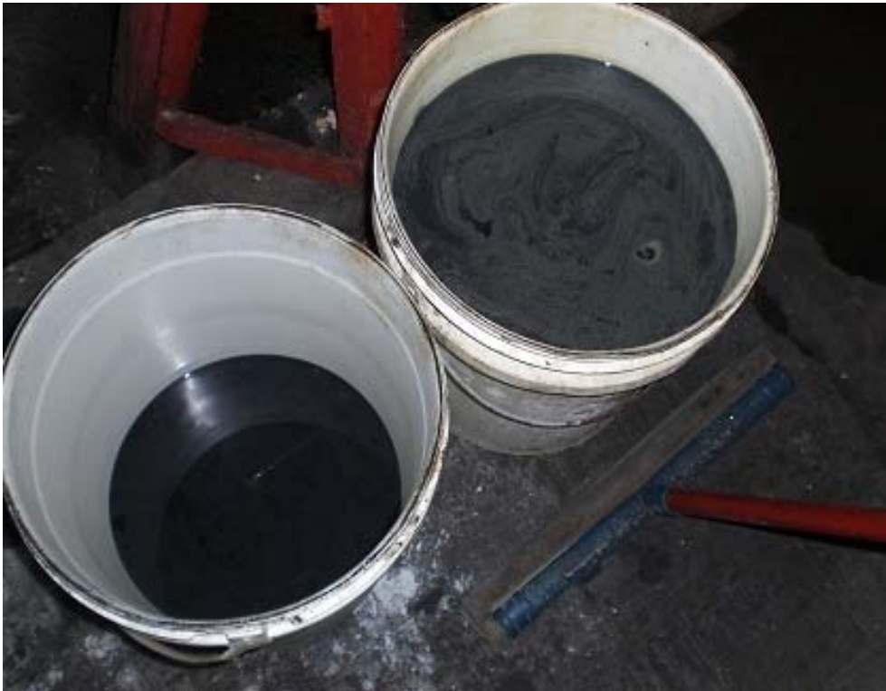
Figura 3.10: Banho residual de curtimento integral para ser reusado.
