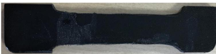
Figura 15: Corpo de prova para o ensaio de tração.
