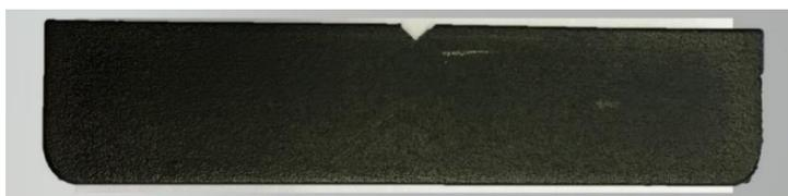
Figura 14: Corpo de prova, com entalhe, para o ensaio de impacto Izod.
