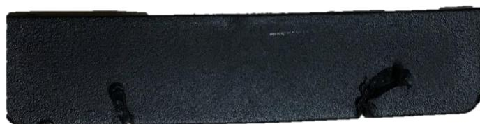
Figura 24: Corpo de prova sem entalhe não rompido após ensaio de resistência ao impacto IZOD.
