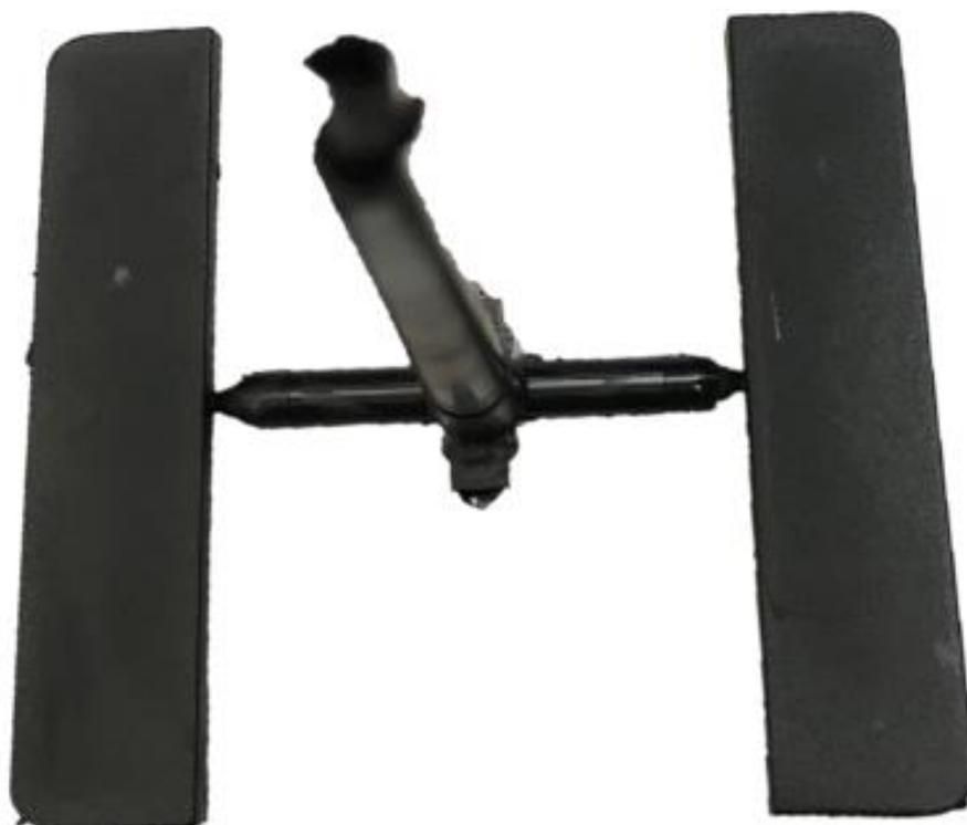
Figura 12: Peça injetada em cavidade dupla, contendo os canais de injeção.
