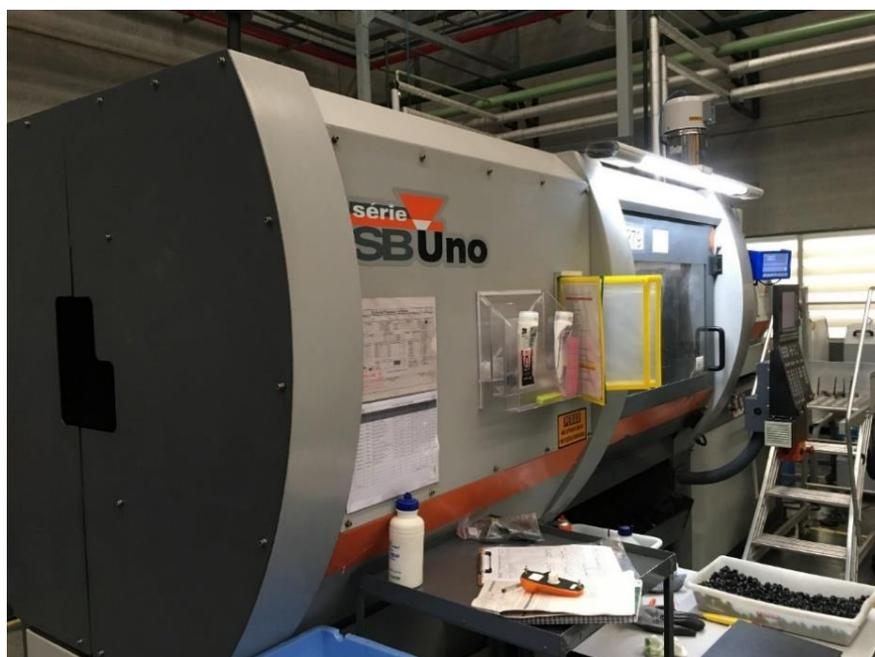
Figura 13: Injetora Sandretto Sb Uno 612/165 utilizada para o processamento das peças.
