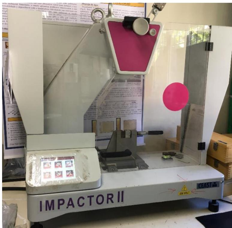
Figura 16: Equipamento utilizado para o ensaio de resistência ao impacto Izod.
