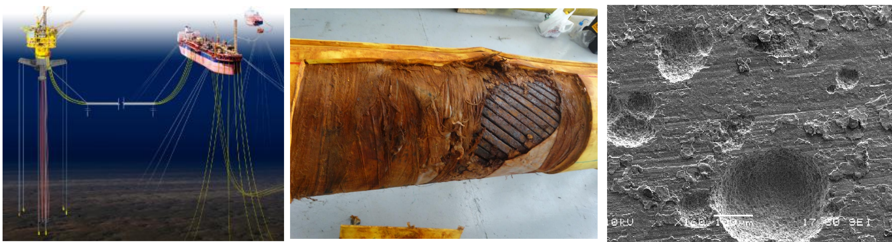
Figura 1: Risers em serviço, duto com capa polimérica danificada, pits de corrosão.
