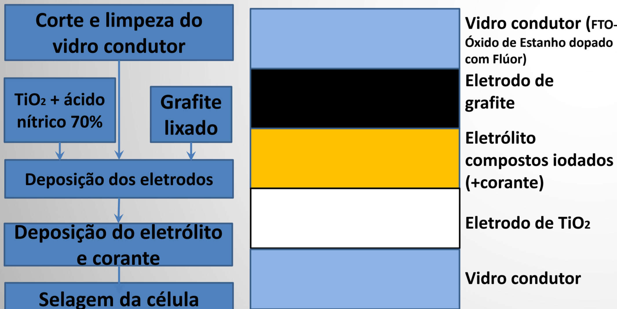
Figura 2 – Representação dos componentes da camada ativa da célula
