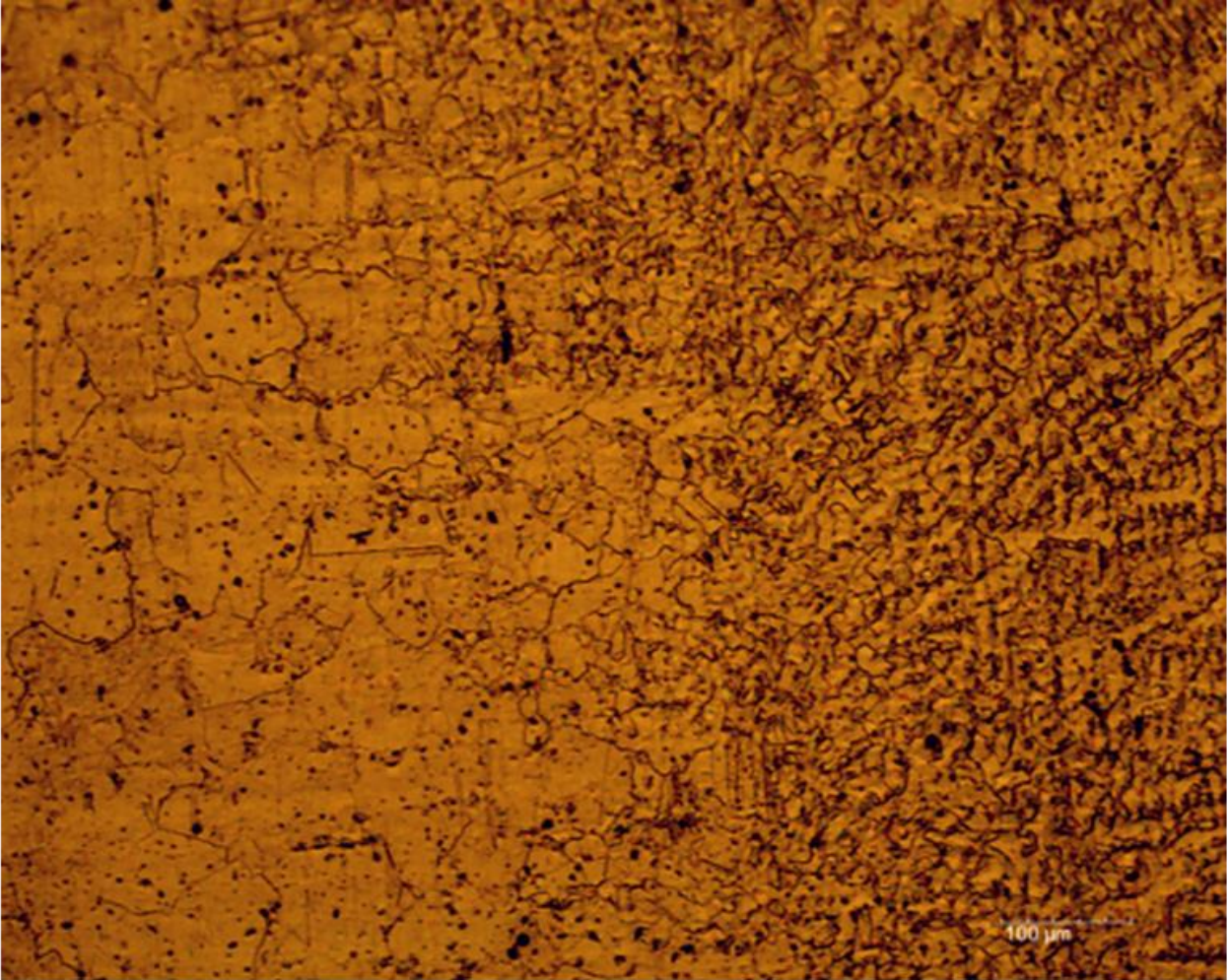
Figura 22 d). Microestrutura da Zona afetada pelo calor (ZAC). Região de crescimento de grão.
