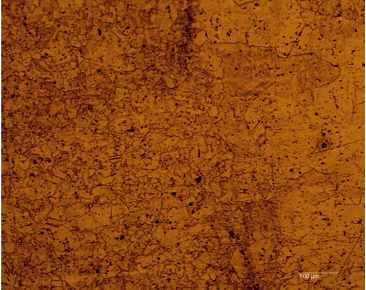
Figura 22 c). Microestrutura da Zona afetada pelo calor (ZAC). Região de refino de grão.
