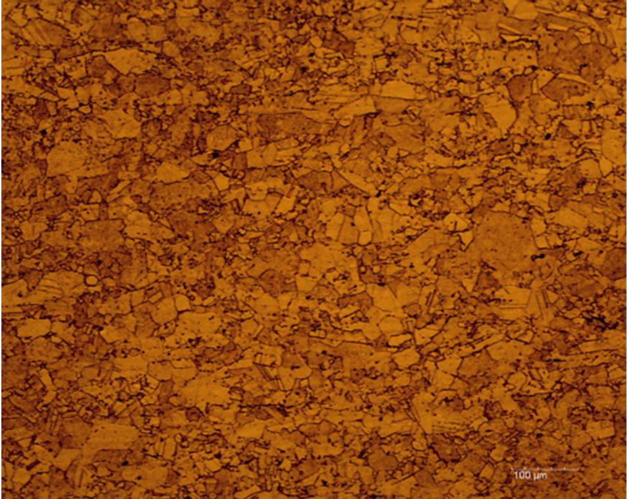
Figura 22 b). Microestrutura do metal base (MB).
