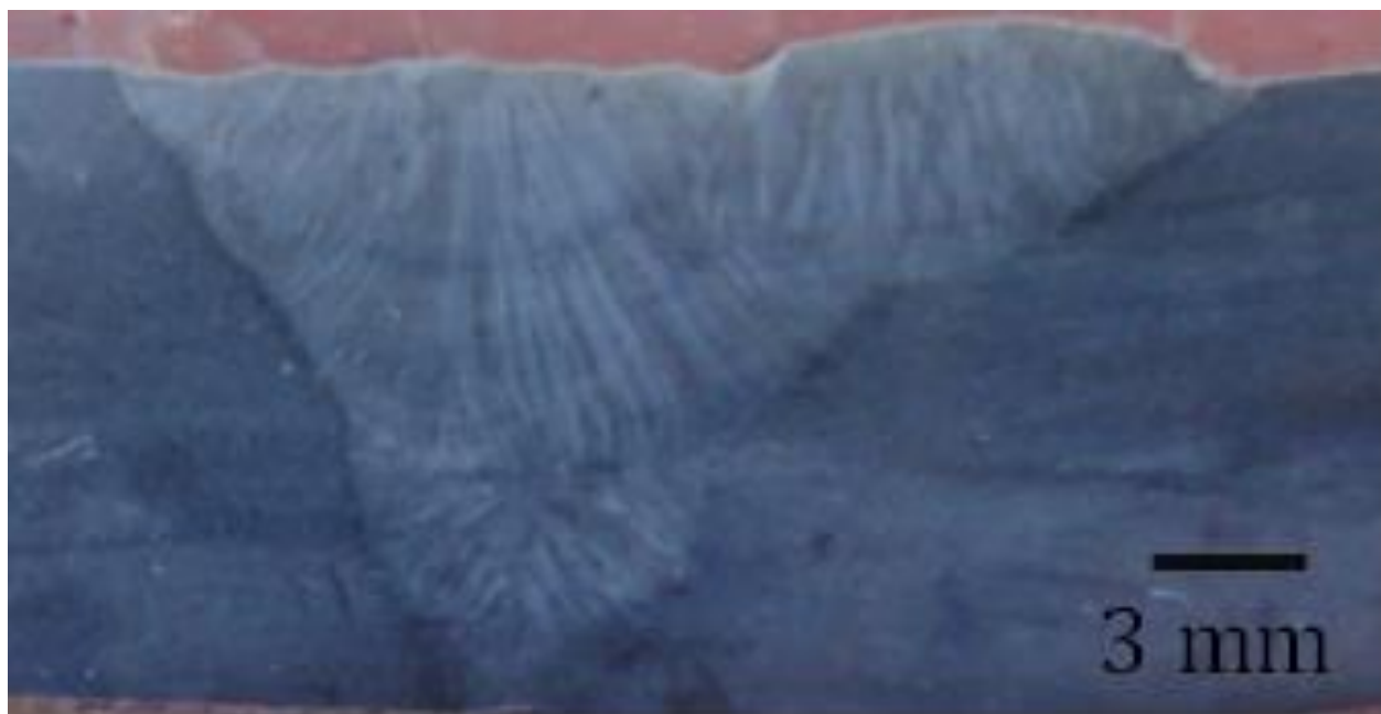
Figura 22 a). Macrografia da secção transversal da junta soldada.
