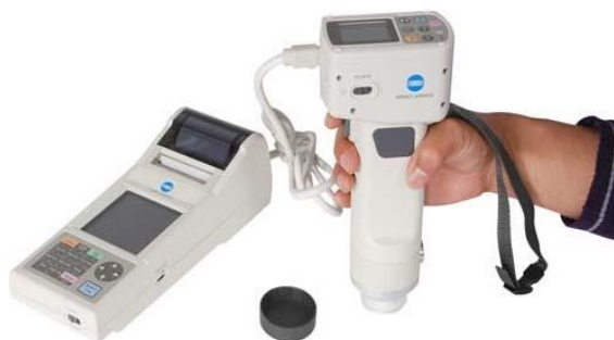
Figura 9 – Colorímetro (modelo CR-300, MinoltaCo. Ltd, Japão) utilizado para determinar a cor dos filmes.
