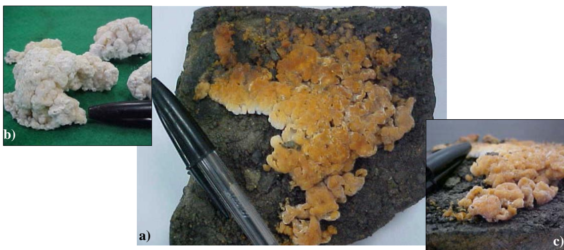
Figura 14: a) Produtos originados sobre a superfície da amostra extraída de maciço rochoso contendo sulfetos, resultantes do processo de oxidação destes minerais; b) Detalhe do produto de coloração branca extraído da amostra; c) Detalhe do produto de coloração alaranjada extraído da amostra.
