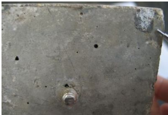
Figura 110: CPM aos 1653 dias de idade: pequena região da aresta do prisma de concreto lascada e coberta por eflorescência branca.
