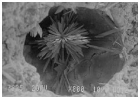
Figura 31: Gipsita formada no interior de um poro da pasta de cimento (AYORA et al., 1998).
