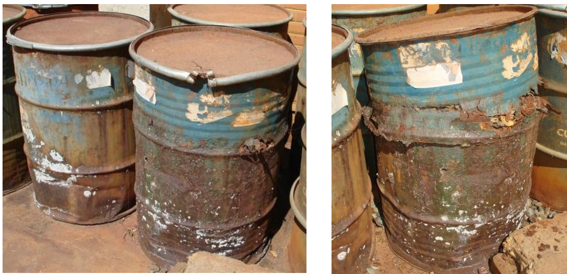
Figura 33: Tambores de aço com agregados contendo sulfetos, provenientes do maciço rochoso de Irapé, corroídos e com eflorações brancas sobre suas superfícies depois de seis anos de armazenamento.
