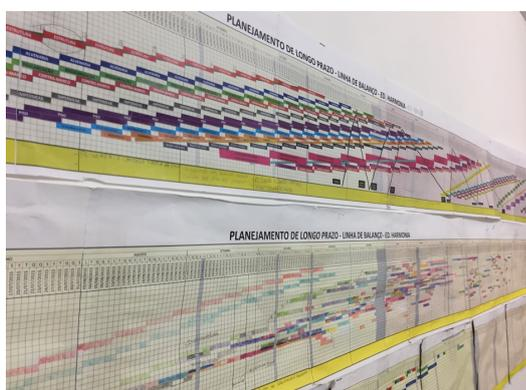
Figura 44 - Linha de balanço "*as built*" da Obra 5 com customização personalizada
