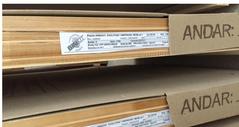
Figura 60 - Incorporação de informação pelo fornecedor ao produto para transparência de processos
