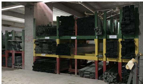
Figura 35 - Estoque de guias e montantes com indicação de cores
