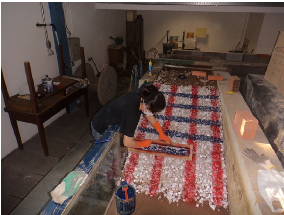
Figura 4.23 – Marcação das listras transversais no talude com tinta azul.
