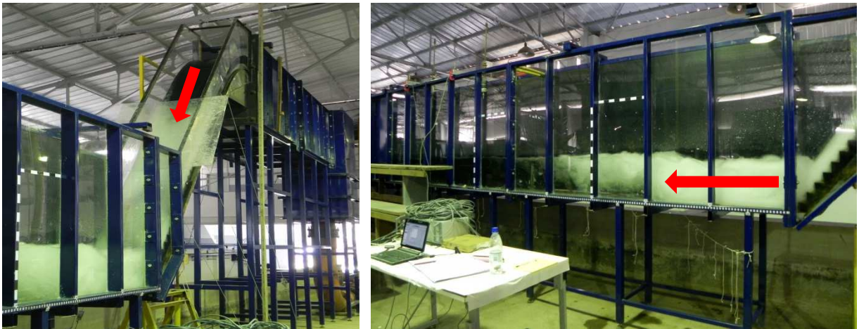
Figura 4.2 – Modelo reduzido utilizado, seta indicando o sentido do escoamento.
