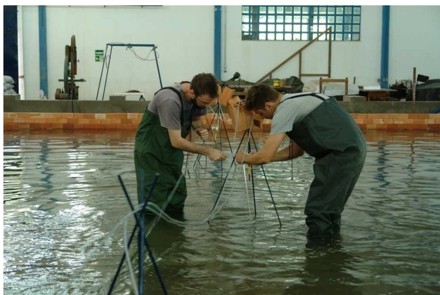
Figura 4.30 - Fixação das sondas a tripés posicionados ao longo do tanque de ondas.
