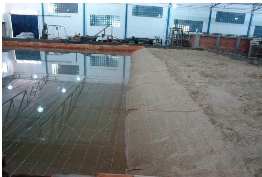
Figura 4.42 - Linhas de nylon posicionadas sobre a superfície superior do talude para auxílio do levantamento topo-altimétrico.
