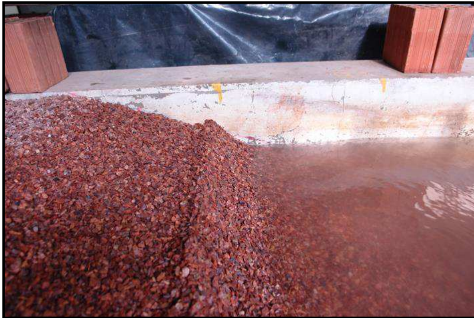
Figura 5.59 - Talude com brita P e inclinação 1:3, após o primeiro teste sob ação de onda tipo C.
