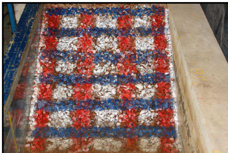
Figura 5.53 - Vista superior do talude, antes da ação das ondas, brita G e inclinação 1:2.
