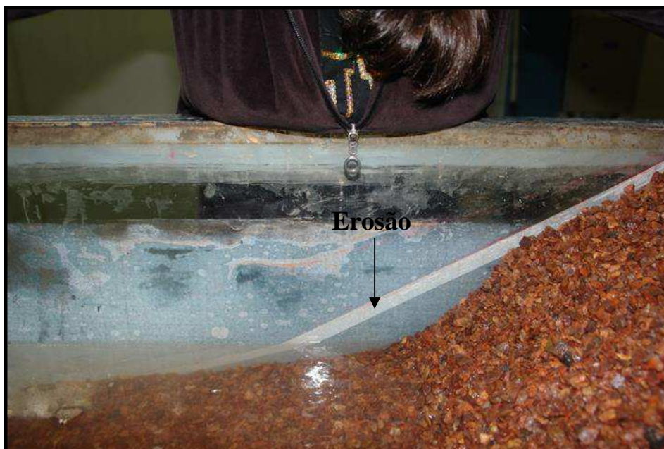
Figura 5.61 - Talude com brita P e inclinação 1:2, após o primeiro teste sob ação de onda tipo C.
