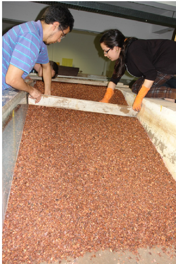
Figura 4.25 – Talude constituído de brita P.
