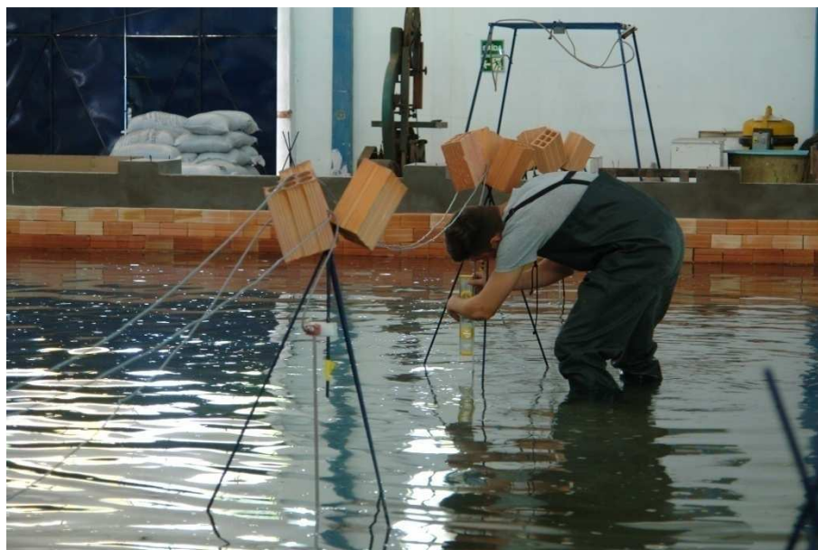
Figura 4.31 - Nivelamento das sondas capacitivas.
