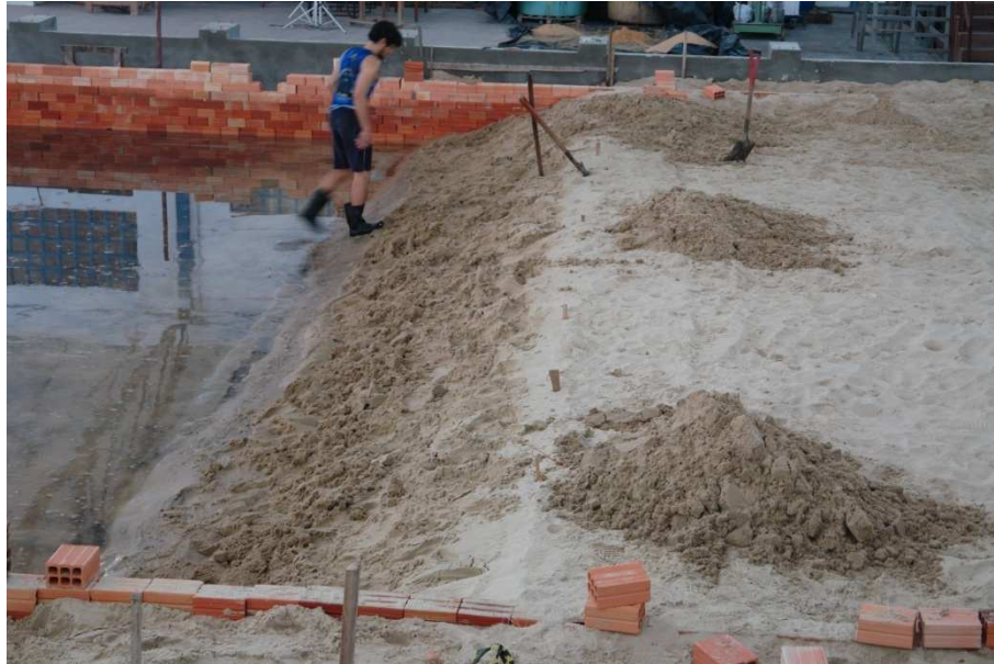
Figura 4.35 - Posicionamento da areia na direção de incidência com as ondas, sem compactação e com inclinação de 1(V):3(H).
