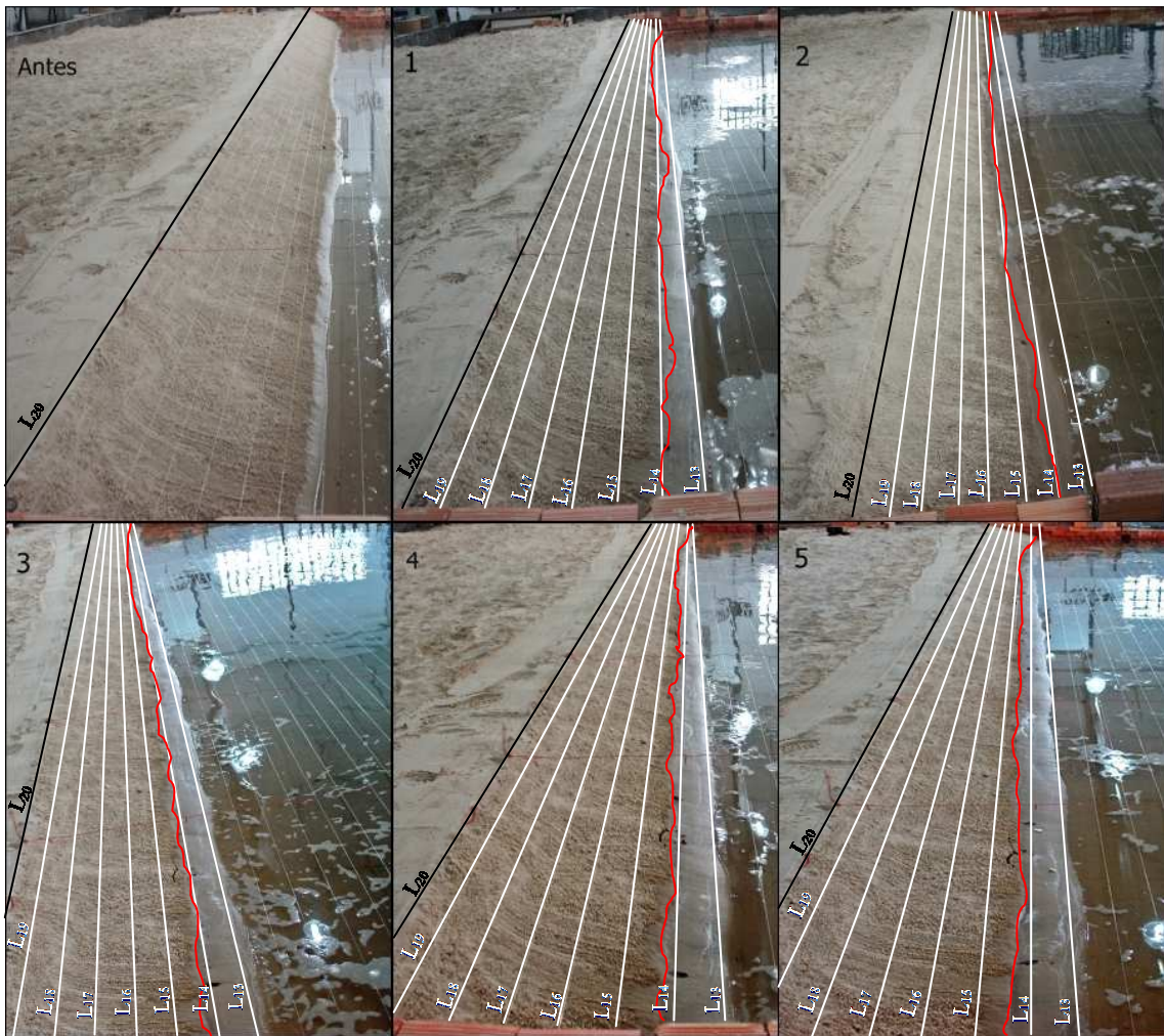
(a) Talude de proteção antes e após os testes T 1 a T 5 .
