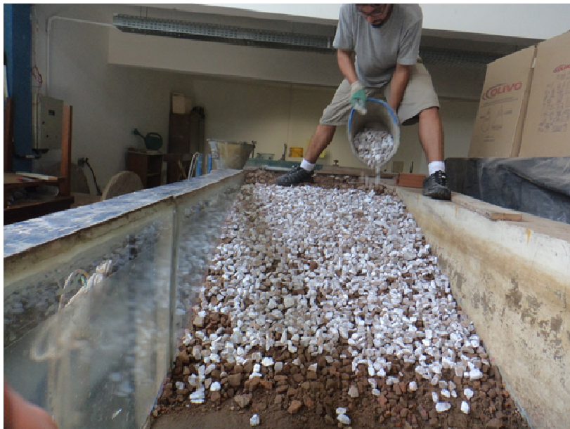
Figura 4.21 – Lançamento da brita G branca sobre o talude sem compactação.
