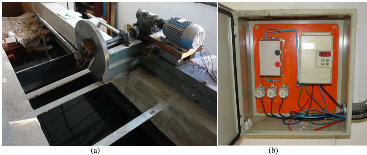
Figura 4.8 – Gerador de ondas do canal (a) e variador de frequência (b).
