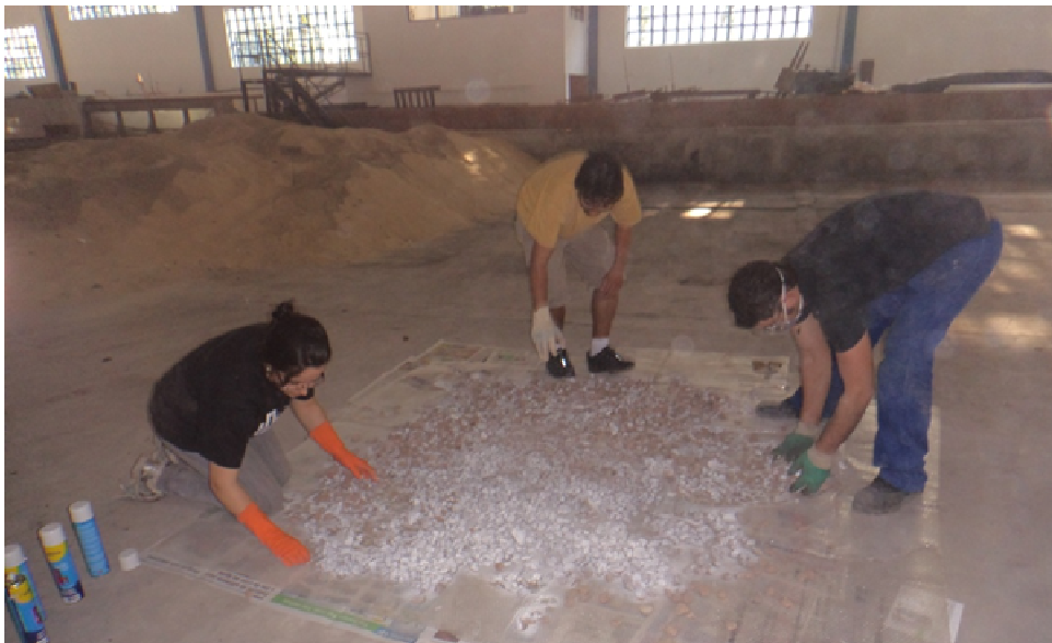
Figura 4.20 – Pintura da brita G com tinta branca para formação de uma superfície de referência e contraste visual no talude.
