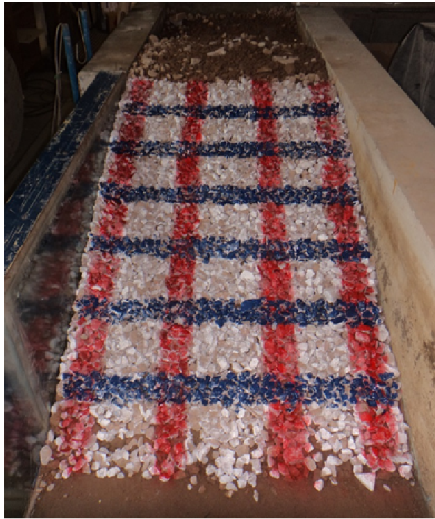
Figura 4.24 – Talude constituído de brita G.
