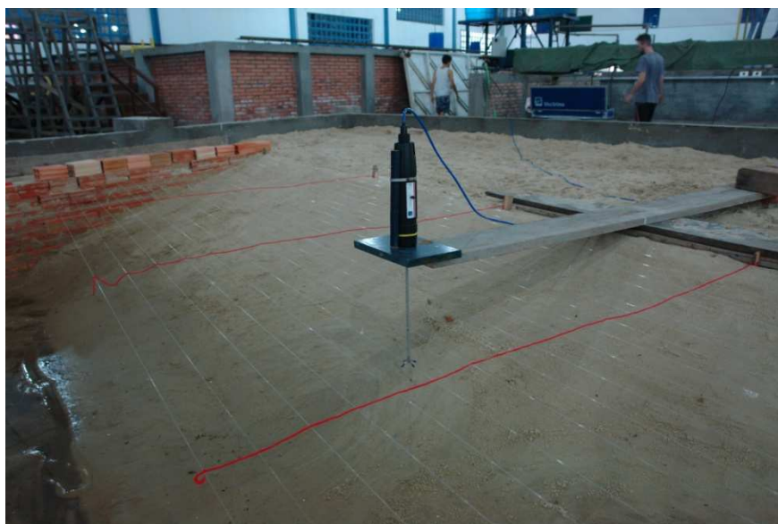
Figura 4.48 - Posicionamento do ADV para medição das velocidades médias das correntes no sentido longitudinal ao talude.
