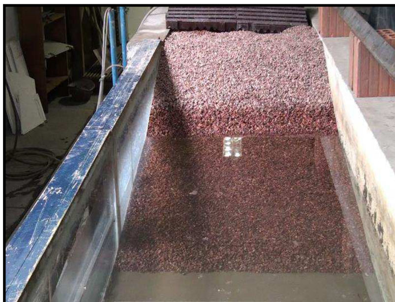
Figura 5.58 - Vista superior do talude, antes da ação das ondas, brita P e inclinação 1:3.
