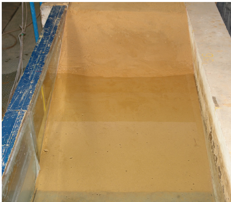
Figura 4.26 – Talude constituído de areia.
