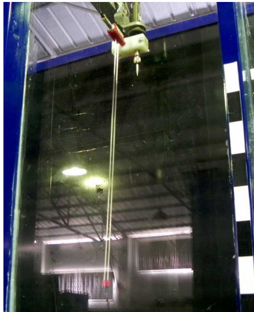
Figura 4.4 – Instalação da sonda sobre a bacia de dissipação.
