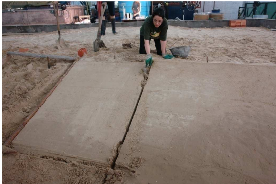
Figura 4.40 - Preenchimento das emendas ocasionadas pela retirada do gabarito de confecção do talude.
