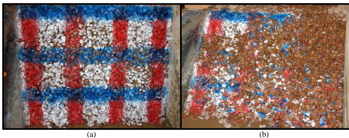
Figura 5.57 – Vista superior do talude, antes de (a) e após (b) a ação das ondas, feito com brita G e inclinação 1:1 sob ação da onda tipo C.
