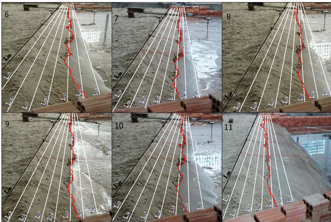
(b) Talude de proteção após os testes T 6 a T 11 .
