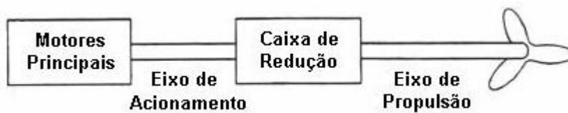
Figura 3.6 – Esquema do sistema de propulsão do navio.
