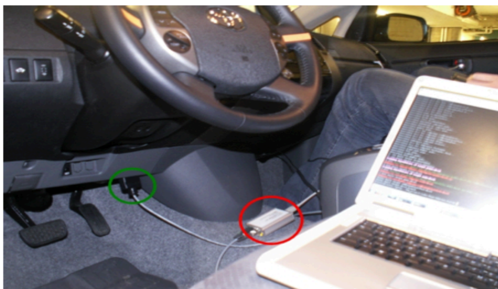
Figura 46: Exemplo de conexão entre dispositivo de aquisição de dados (círculo vermelho) e a porta de comunicação (círculo verde) em um veículo Toyota Prius.
