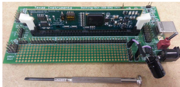
Figura 14 – Kit de desenvolvimento com o DSC TMS320F28335 Delfino™.
