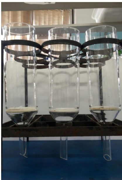
Figura 5 – Frascos de vidro cilíndricos usados como biorreatores em estado sólido.
