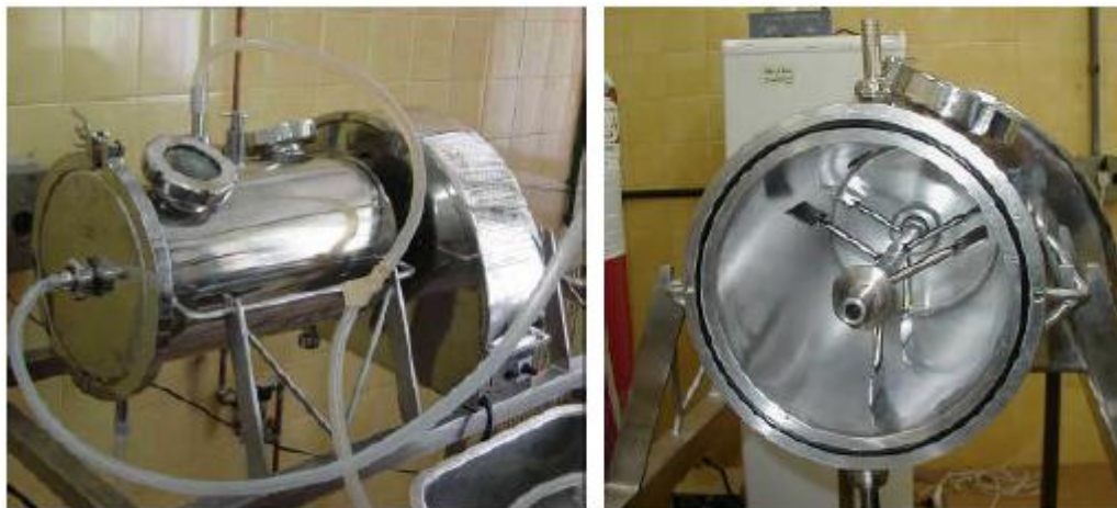
Figura 6 – Visões externa e interna do biorreator cilíndrico de tambor agitado.
