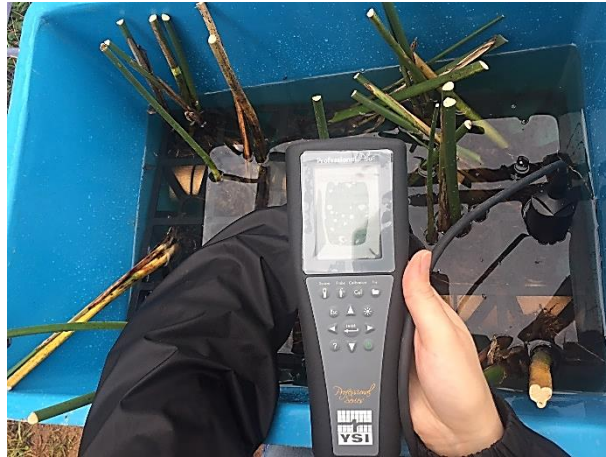
Figura 19. Utilização de sonda multiparâmetros YSI – Professional Series para aferição de parâmetros in situ .
