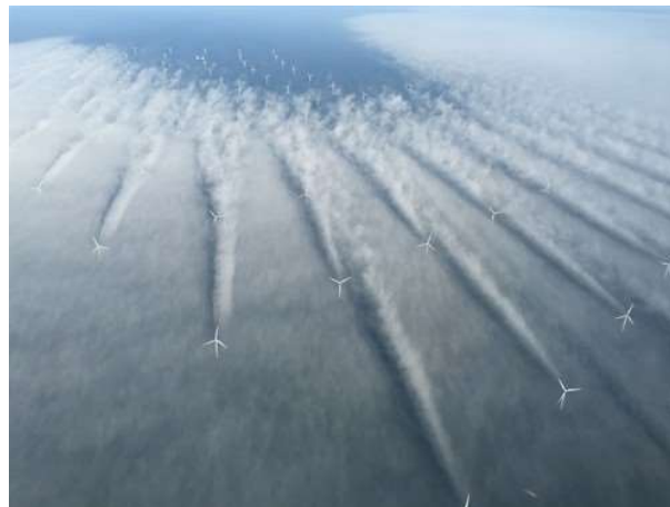
Figura 1.1 - Efeitos da esteira aerodinâmica no parque eólico Offshore Horns Rev 2. (Fonte:www.belair.dk)
