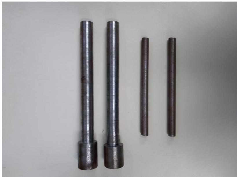
Figura 6.2 - Dois pinos com 17 mm de diâmetro (à esquerda) e dois pinos com 9,5 mm de diâmetro (à direita), usinados no próprio GMAp.
