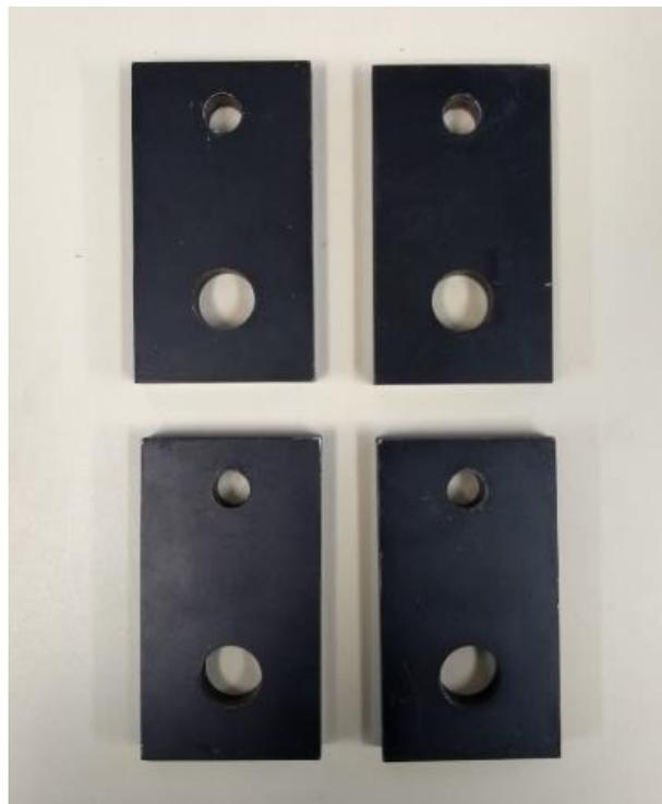
Figura 6.1- Quatro placas de aço 1020 projetadas para o ensaio, após a aplicação de tinta spray na cor preta.
