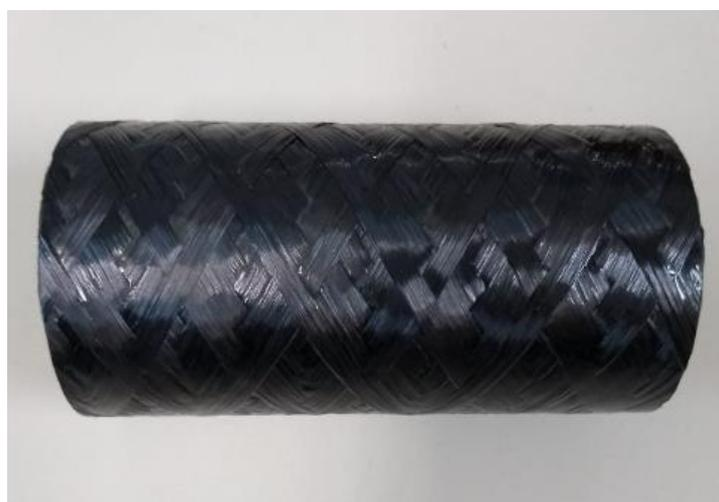
Figura 6.3 - Vista lateral do compósito produzido por enrolamento filamental.
