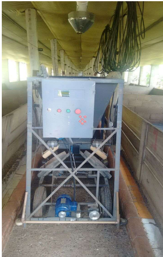
Figura 26. Robô criado pelo sucessor para automatizar a alimentação dos suínos.
