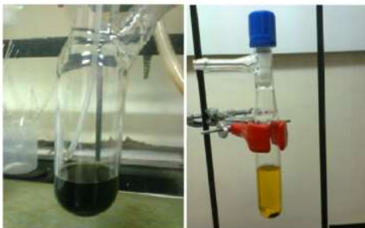
Figura 29. Sistema catalítico Rh-Cp' após exp. 10: (a) após a transferência para o tubo de Schlenk ; e (b) após 30 minutos em repouso.
