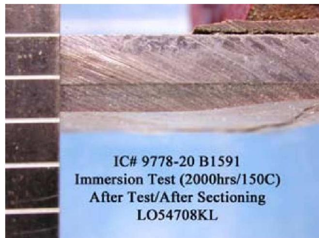
Figura 4.8 Amostra do revestimento Belzona 1591 em corte transversal, submetido a exame visual por MEV, após ensaio por imersão em 150°C por 2000h (QUINTELA 2006).
