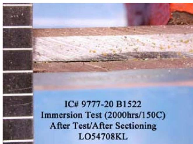
Figura 4.9 Amostra do revestimento Belzona 1522 em corte transversal, submetido a exame visual por MEV, após ensaio por imersão em 150°C por 2000h (QUINTELA 2006).
