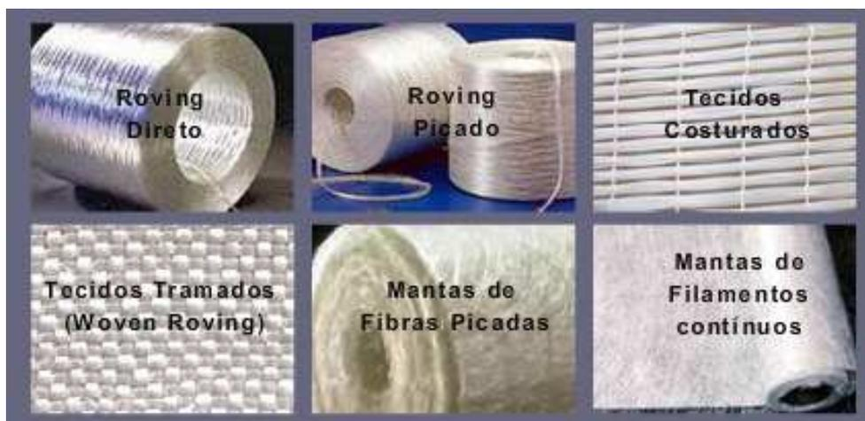
Figura 2.20 Formas usuais disponíveis em fibras de vidro para aplicação em compósitos (POLYPLASTER, 2009).
