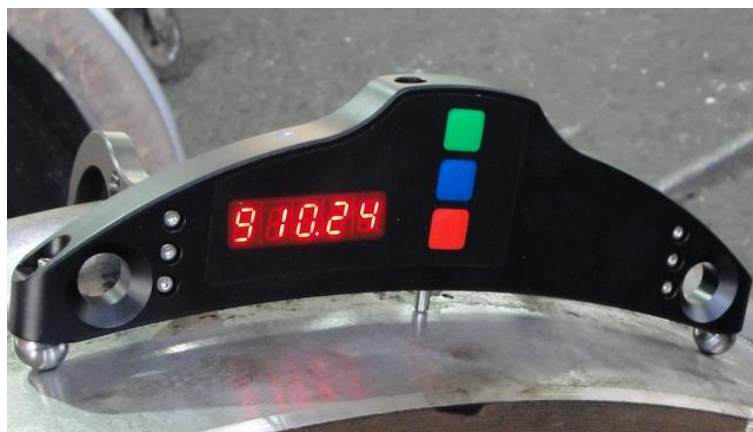
Figura 3.1 – medidor de diâmetros por três pontos da marca RiFtec (fonte: http://www.ascorail.eu ).
