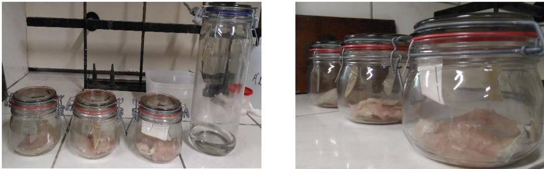
**Figura 3:** À esquerda, Três potes menores contém aproximadamente 60 gramas de peixe cada, além de acondicionar os sensores, PP Branco, PP 1A, PP 2, PP 5B e PP 6A e 2. Os potes menores acondicionam dois sensores cada, com exceção de um que acomoda três sensores. Pote maior acomoda todos os cinco sensores e contém hidróxido de amônia. À direita, detalhe do headspace de 3 centímetros entre os sensores PP Branco, PP 1A, PP 2, PP 5B, PP 6A e a proteína animal.
