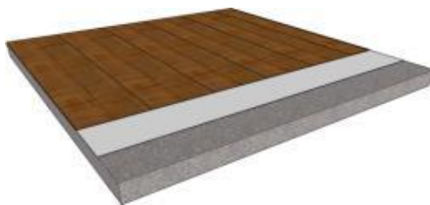
Figura 20 - Ilustração do revestimento final e a fina camada resiliente
