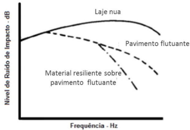
Figura 17 - Isolamento de ruído de impacto para tipologia de lajes
