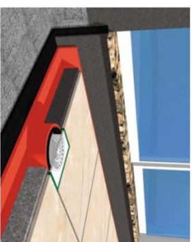
Figura 9 – Detalhe padrão da interface manta/impermeabilização/ralo
