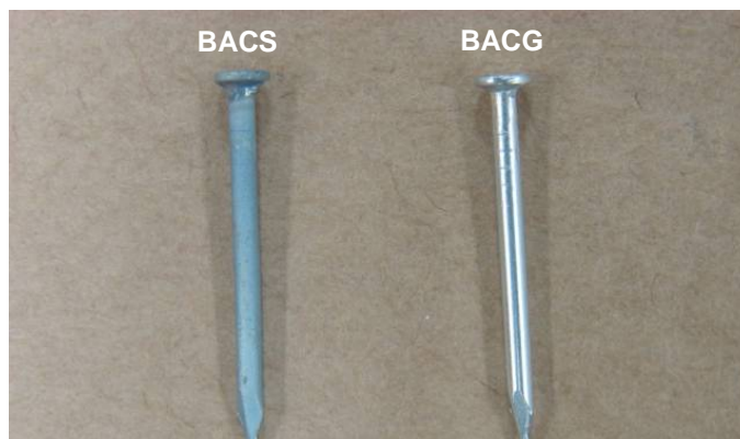
Figura 26: Prego 12x12 galvanizado na faixa máxima de pH do banho.
