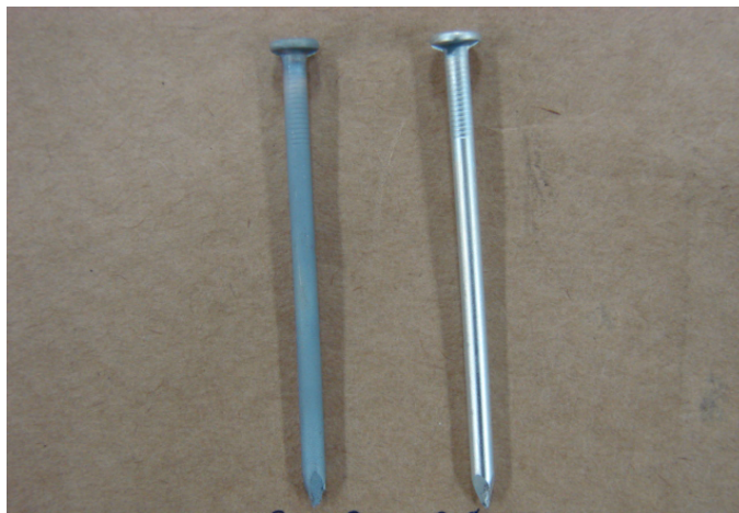
Figura 28: Prego 16x24 galvanizado na faixa máxima de pH do banho.
