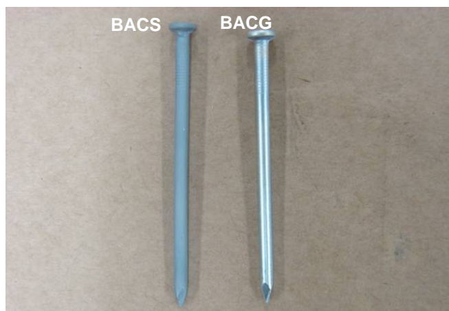
Figura 31: Prego 16x24 galvanizado na faixa mínima de pH do banho.
