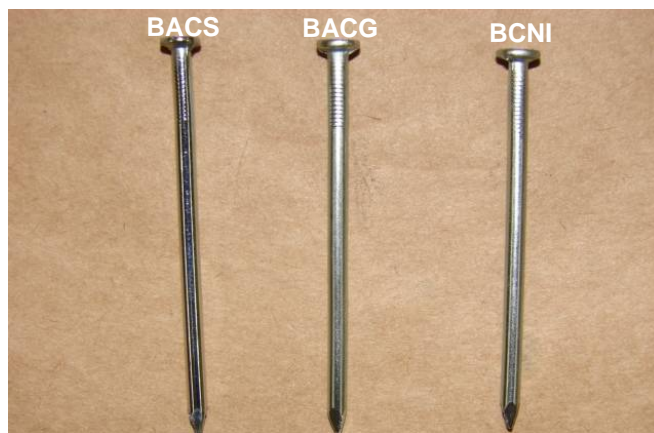
Figura 25: Prego 16x24 galvanizados à temperatura mínima do banho.
