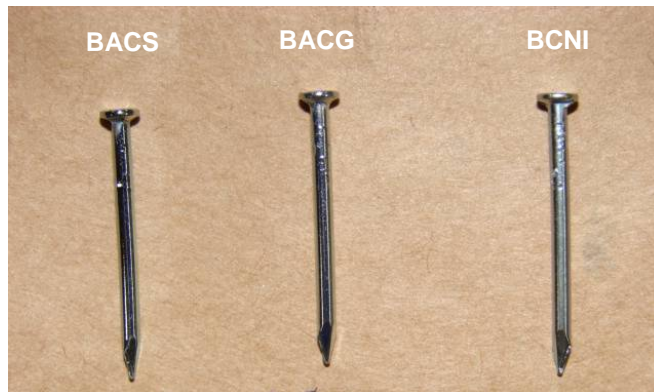
Figura 24: Prego 12x12 galvanizados à temperatura mínima do banho.
