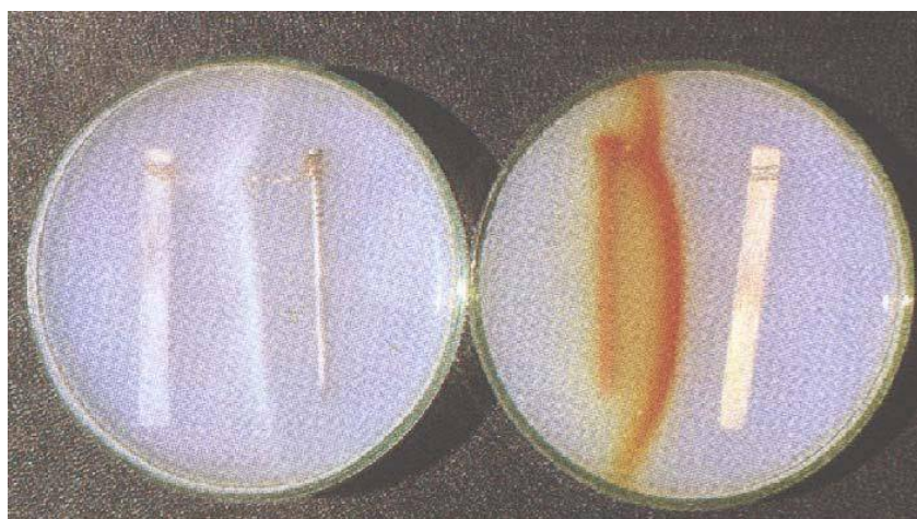
Figura 2: Experiência de par galvânico, após sete dias. No primeiro, o produto de corrosão de coloração branca é da corrosão do zinco. No segundo, o produto de corrosão avermelhada é da corrosão do ferro. Fonte: GENTIL, 2003, p.52
