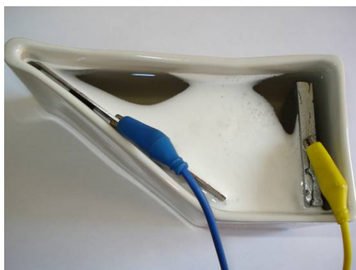
Figura 8: Célula de Hull em funcionamento: como cátodo, uma chapa de aço e como anodo, uma chapa de zinco.
