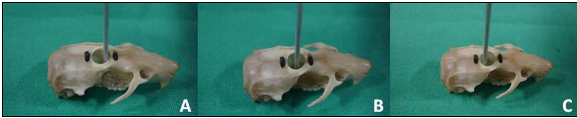
Figura 4: Mensuração do campo magnético no limite anterior (A), no centro (B) e no limite posterior (C) do defeito ósseo.
