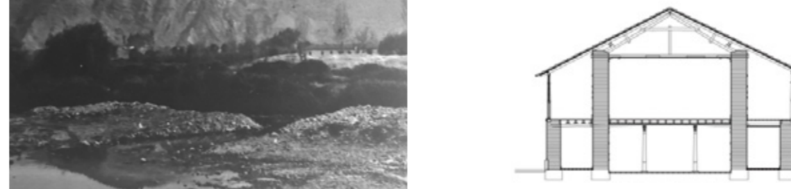
Figura 42 — Corte transversal da casa mostrando os grandes muros de adobe, as estruturas internas de madeira e as telhas de barro.
