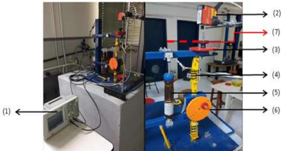
Figura 3.1- Visão da Bancada: (1) osciloscópio, (2) laser, (3) massa disco, (4) mola "5", (5) amortecedor, (6) motor anexado a um disco de massa desbalanceada, (7) distância amortecedor-ponto de medição
