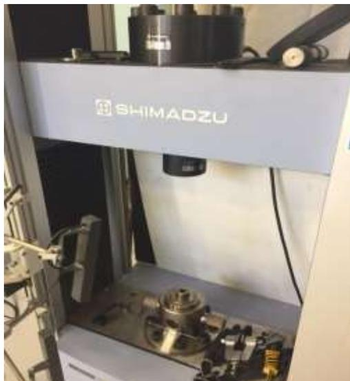
Figura 3.4- Máquina de ensaios universais.
