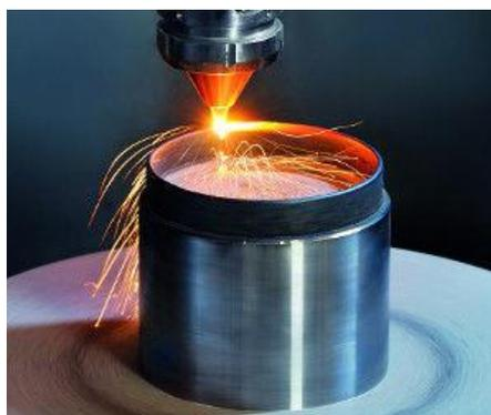
Figura 2.2 – Exemplo de uma amostra executada por manufatura aditiva [Direct Industry, 2018].
