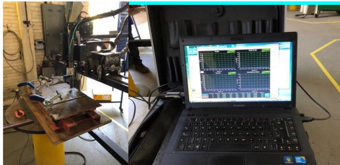
Figura 3.1 – Robô CNC (Tartilope) à esquerda e SAP4.01 à direita.
