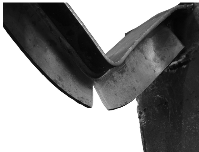
Figura 7. Ruptura da alma do perfil T por deflexão excessiva.
