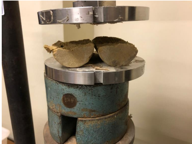
Figura 4.13 – Ensaio de compressão diametral (Fonte: autor)
