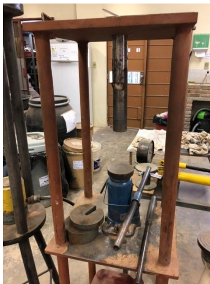
Figura 4.9 – Prensa acionada por macaco hidráulico (Fonte: autor)
