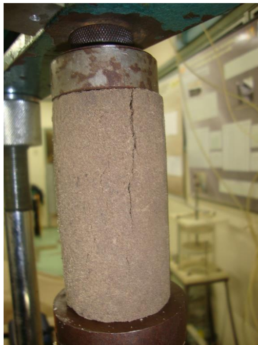
Figura 4.10 – Ensaio de compressão simples (Fonte: autor)
