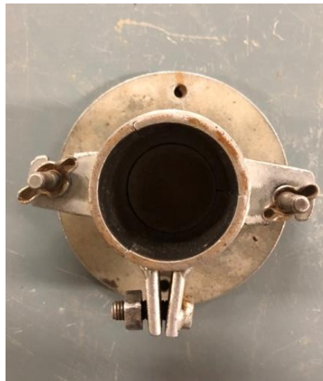
Figura 4.7 – Molde cilíndrico (Fonte: autor)
