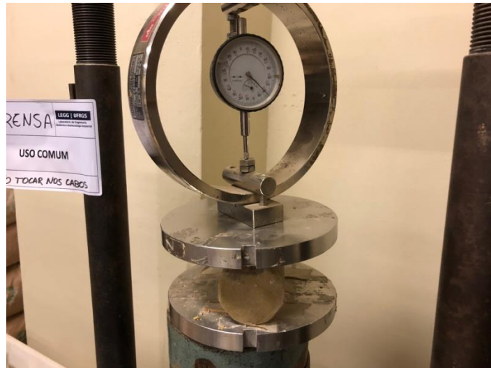
Figura 4.11 – Ensaio de compressão diametral (Fonte: autor)
