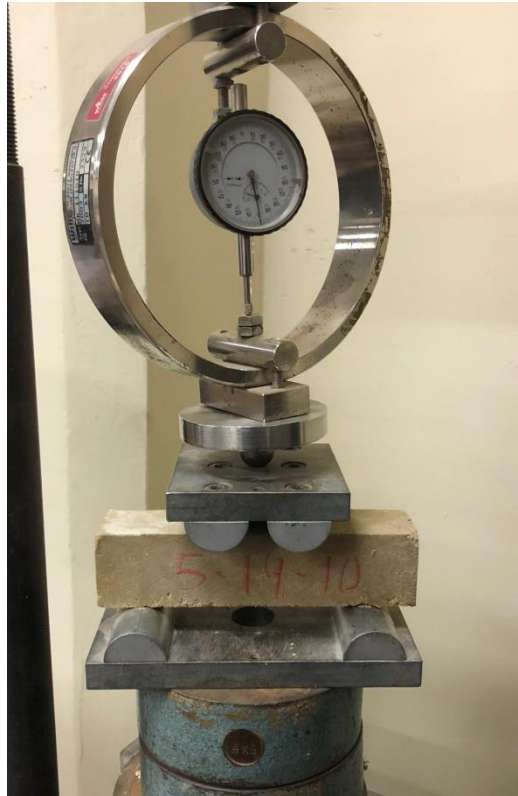
Figura 4.14 – Ensaio de flexão (Fonte: autor)
