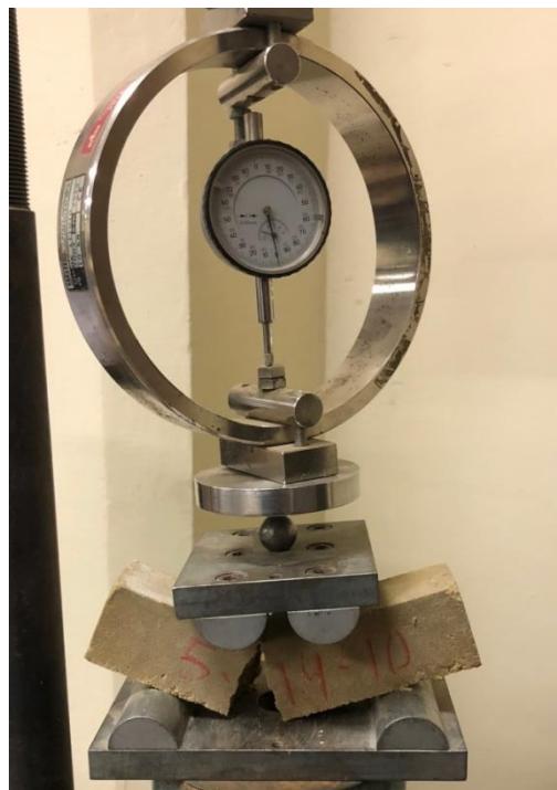
Figura 4.15 – Ensaio de flexão (Fonte: autor)
