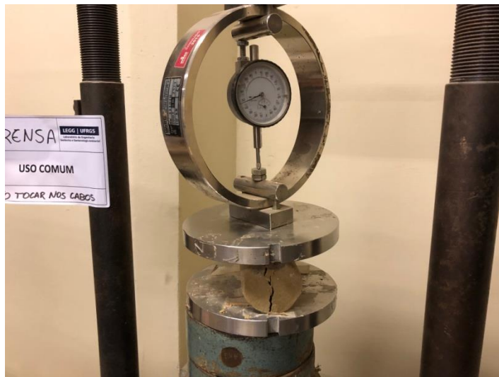
Figura 4.12 – Ensaio de compressão diametral (Fonte: autor)
