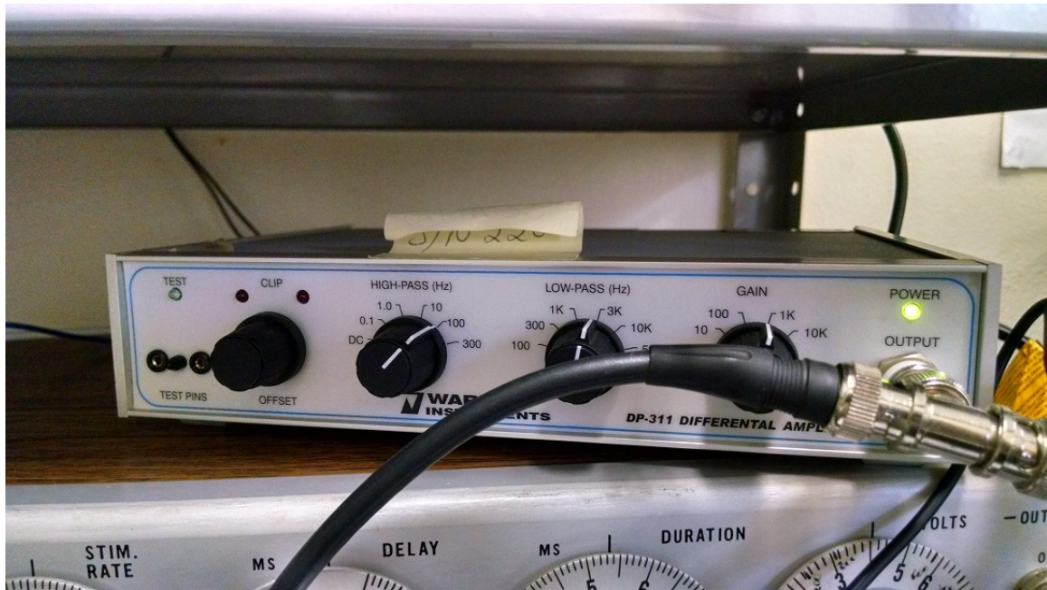
Figura 3.5: Amplificador, cujo sinal recebido do pré-amplificador é potencializado para ser lido pela placa.
