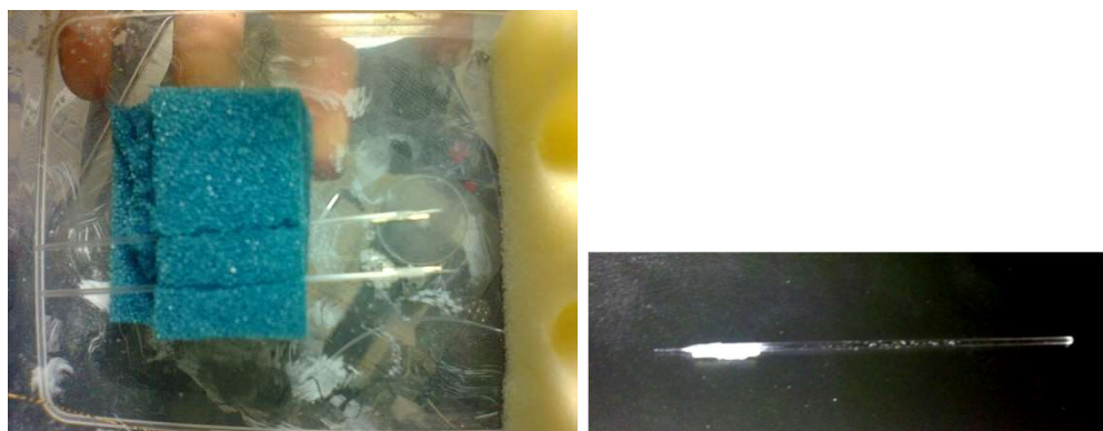
Figura 2: Pipetas de vidro anexadas a cânulas versão 1 (cânula de 9mm e agulha a 0,2mm da ponta da pipeta)
