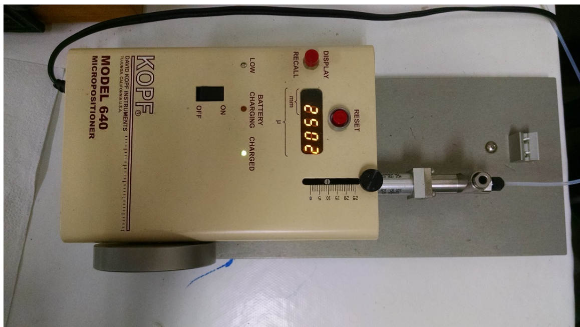
Figura 3.7: Micro-posicionador, utilizado para a descida do eletrodo de registro
