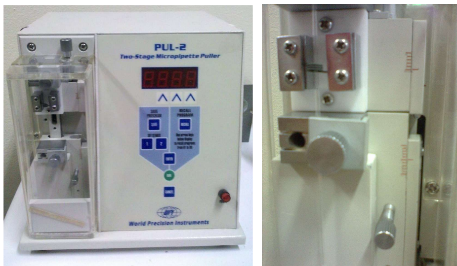
Figura 1: Detalhe do estirador de pipetas mostrando réguas dos andares
