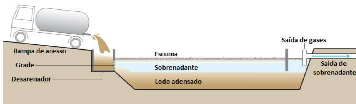
Figura 10. Esquema de uma lagoa de secagem de lodo (Fonte: Tilley et al. , 2014).
