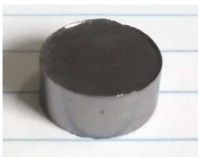
Figura 25. Cilindro de lodo compactado a 60 MPa utilizado na análise de EDS.
