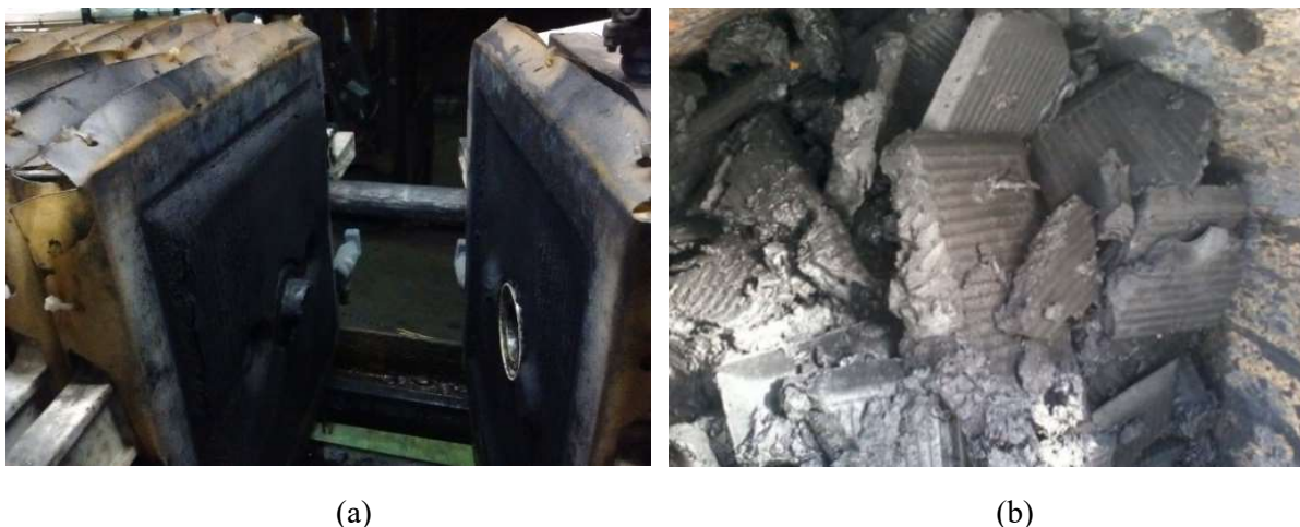
Figura 24. Remoção da torta de lodo filtrada das placas do filtro prensa da empresa (a). Aspecto do lodo de forjaria após processamento em filtro prensa (b).
