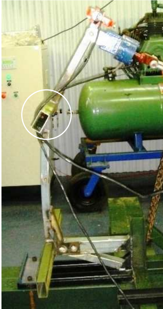
Figura 5.3: Configuração deformada final do corpo de provas ULB2F.
