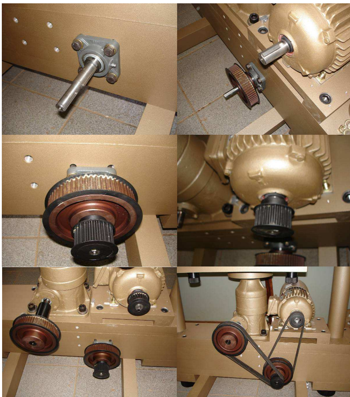
Figura 3.45 – Montagem do sistema de polias e correias sincronizadoras
