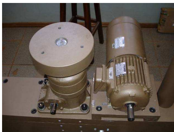
Figura 3.40 – Montagem do prato da prensa
