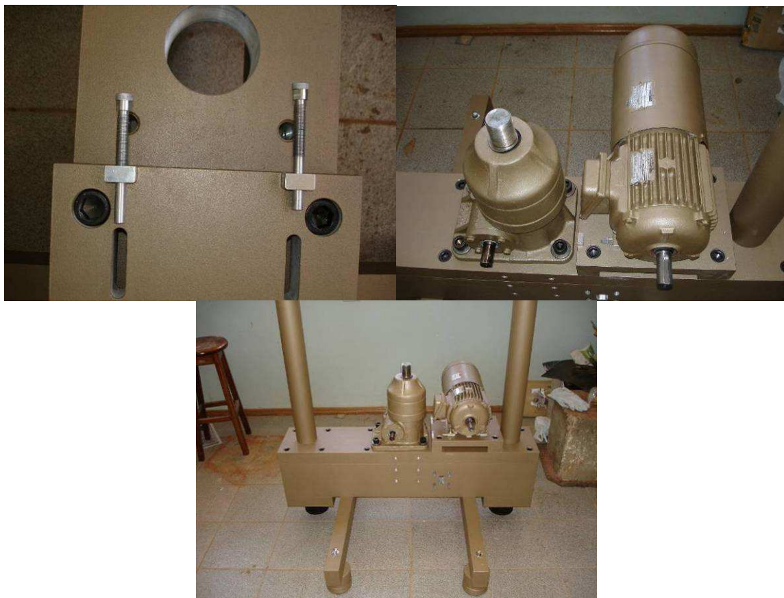
Figura 3.39 – Montagem do motor e do macaco
