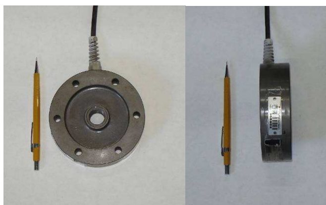
Figura 3.58 – Célula de carga Gunt Hamburg LT 5/3
