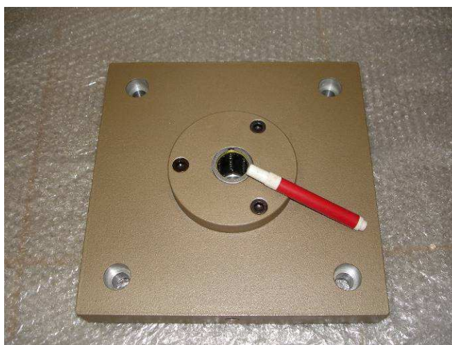
Figura 3.47 – Montagem da bucha para rolamentos lineares na base do cilindro pneumático
