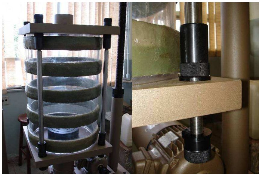
Figura 3.43 – Montagem do Topo da Câmara e aperto com as Porcas
