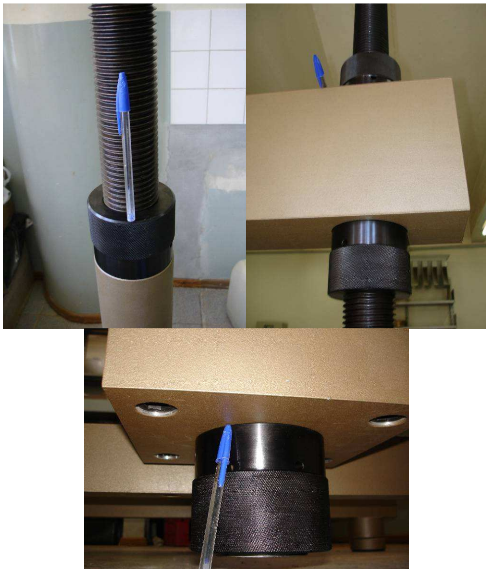
Figura 3.38 – Fixação das hastes roscadas com porcas
