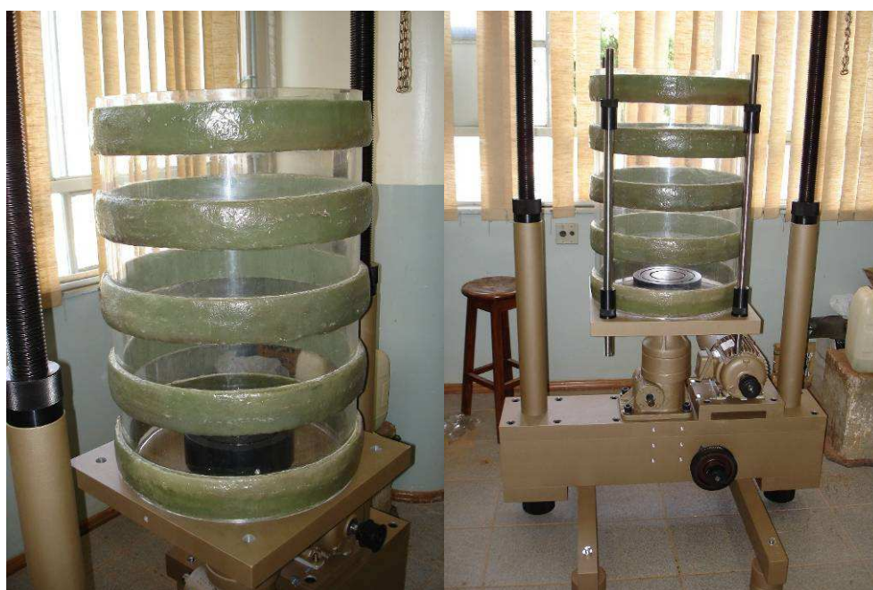
Figura 3.42 – Montagem do acrílico reforçado, das hastes e das contra-porcass
