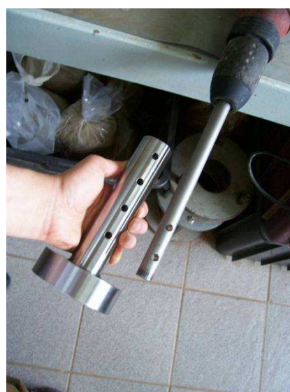
Figura 4.5 – Martelo rompedor HILTI TE 706 utilizado para a compactação
