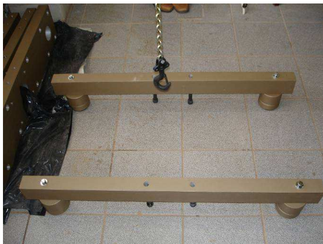
Figura 3.31 – Vigas de sustentação sobre cilindros espaçadores e vibra-stops
