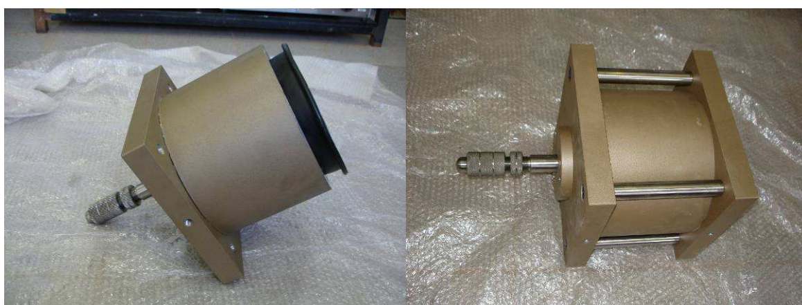
Figura 3.49 – Montagem do cilindro pneumático
