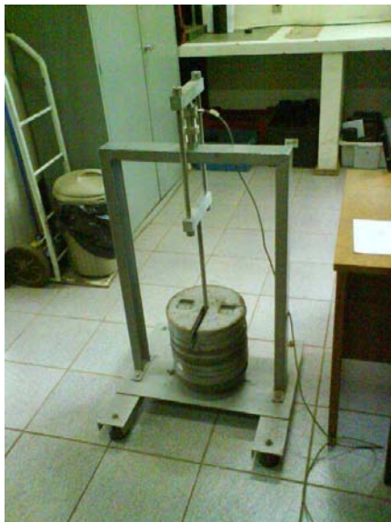
Figura 3.72 – Calibração de célula de carga com pórtico e pesos
