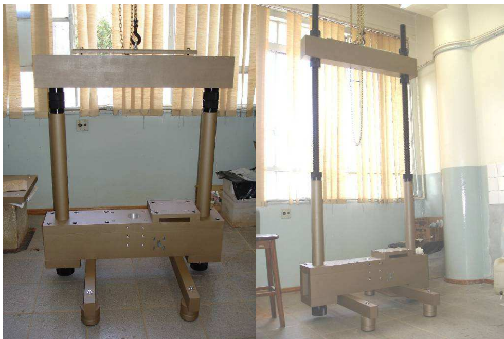
Figura 3.37 – Montagem da viga superior e dos fusos
