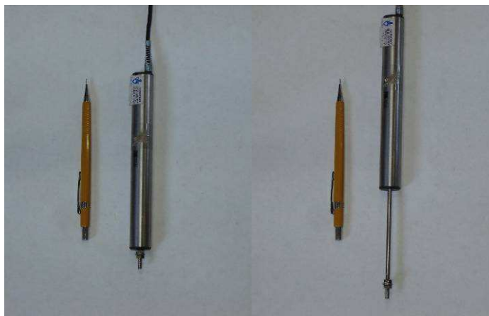
Figura 3.53 – Transdutor de deslocamento do tipo LVDT Solartron AC-25
