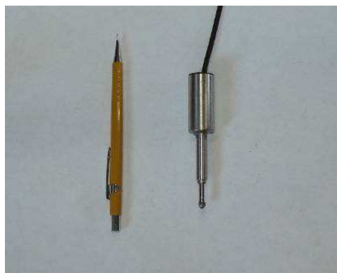
Figura 3.68 – Transdutor de deslocamento LVDT Solartron DG-2,5
