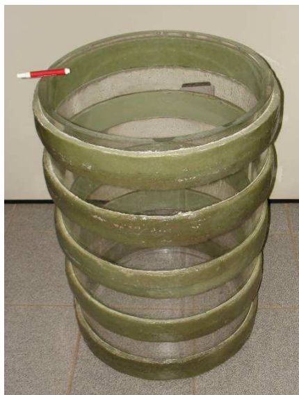
Figura 3.14 – Tubo de acrílico reforçado por anéis de fibra de vidro em resina de poliéster
