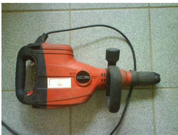
Figura 4.5 – Martelo rompedor HILTI TE 706 utilizado para a compactação
