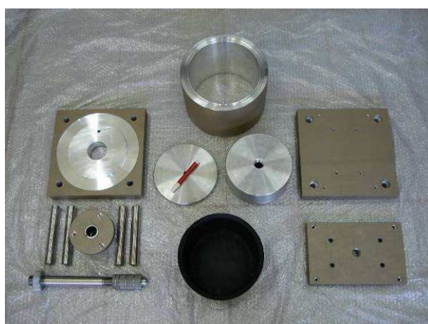
Figura 3.21 – Cilindro pneumático: (a) foto das peças e (b) esquema de montagem
