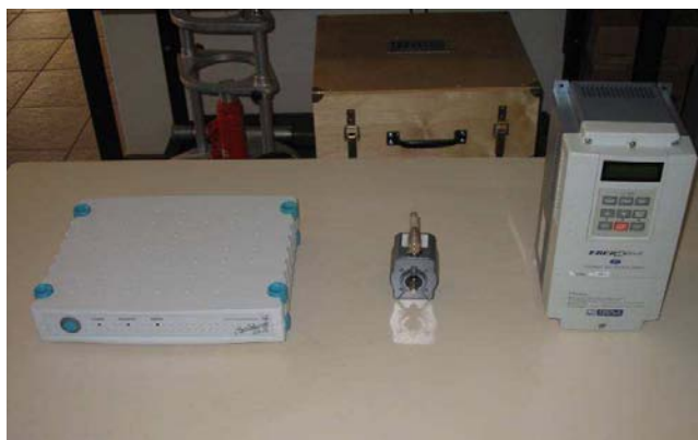
Figura 3.20 – Sistema de aquisição e controle de dados, encoder e inversor de frequência
