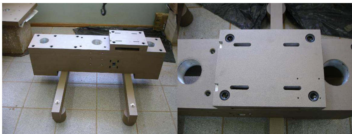
Figura 3.35 – Montagem da base do motor
