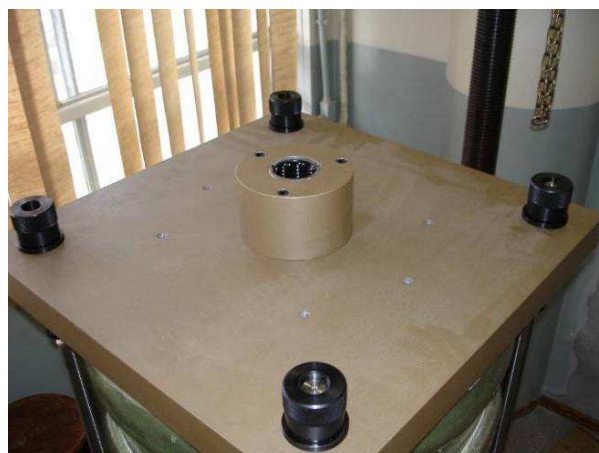
Figura 3.44 – Visão geral do topo da câmara com bucha para rolamentos lineares e porcas
