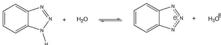
Esquema 1. Hidrólise do 1H-1,2,3-benzotriazol.
