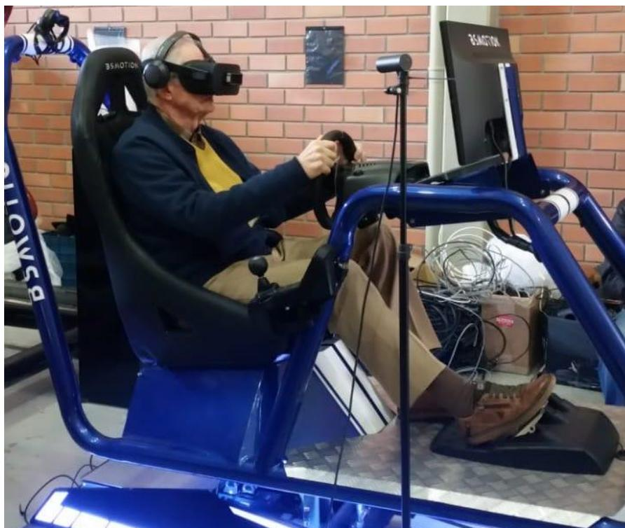
**Figura 1:** Simulador de direção imersivo
